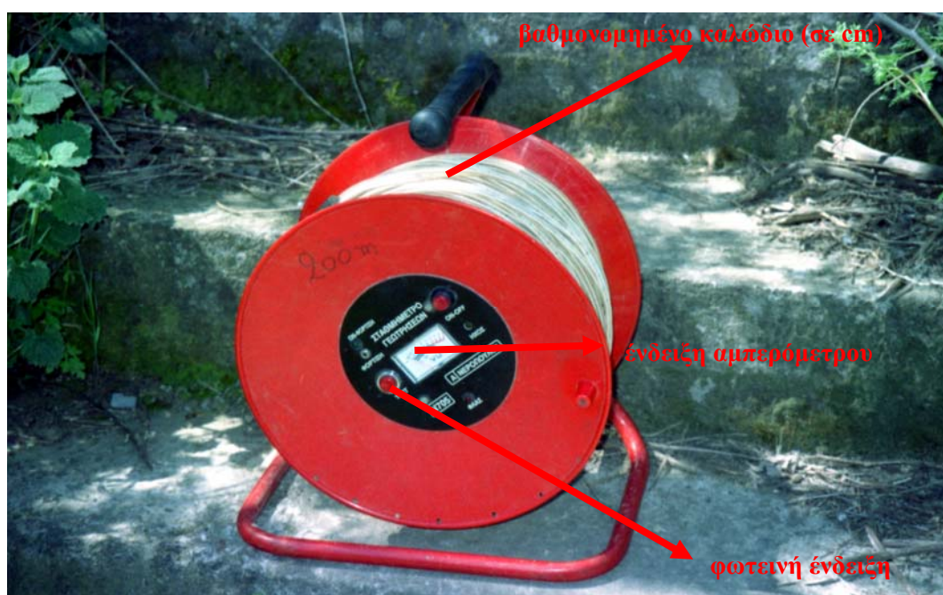
Σχήμα 49. Σταθμήμετρο (κύρια μέρη του)
