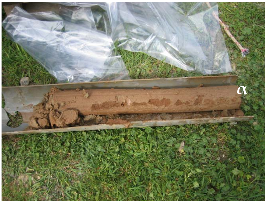
Εικόνα 8 α,β. Εδαφικά δείγματα (καρότα) που συλλέχθηκαν κατά την πυρηνοληψία
