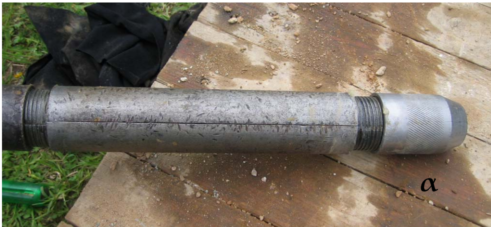
Εικόνες 4 α,β . Πρότυπος διαιρετός δειγματολήπτης Terzaghi
