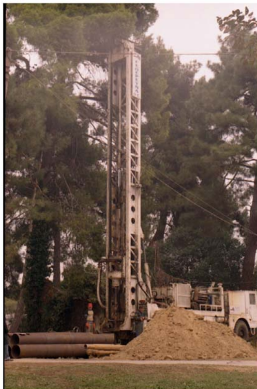
Εικόνα 10 . Το αυτοκινούμενο γεωτρητικό συγκρότημα, όπου φαίνεται ο πύργος των 11 μέτρων
