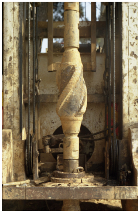
Εικόνα 30 . Κεντρωτής ( Centerliner ) που χρησιμοποιήθηκε σαν οδηγός κατά τη διάρκεια της διεύρυνσης σε συνδυασμό με το τρίκωνο με καρβίδια, διαμέτρου 15 ½ ιντσών
