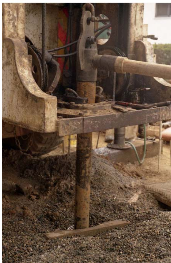
Εικόνα 38 . Η διάταξη του Air- lift σε σχήμα «Γ»
