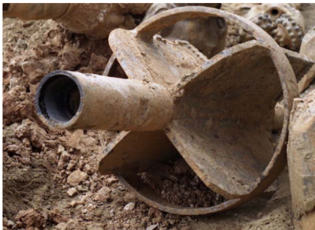
Εικόνα 22 . Τετράφτερο , διαμέτρου 24 ιντσών
