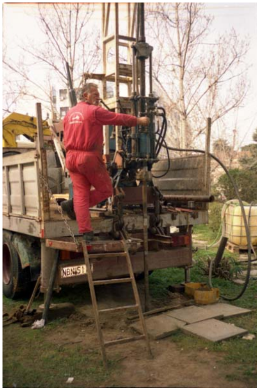
Εικόνα 1 . Το αυτοκινούμενο γεωτρητικό συγκρότημα και η δεξαμενή νερού που ανεφοδιαζόταν από παρακείμενη βρύση
