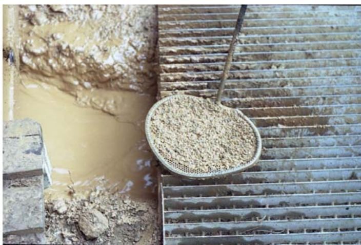
Εικόνα 16 . Δειγματοληψία με σίτα των τριμμάτων που βγαίνουν από τη γεώτρηση
