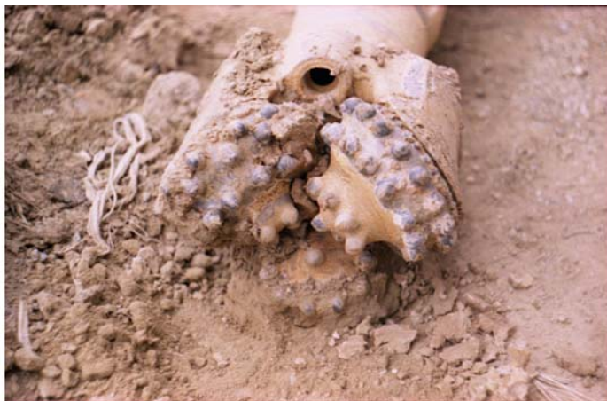
Εικόνα 19 . Τρίκωνο με καρβίδια, διαμέτρου 12 ½ ιντσών
