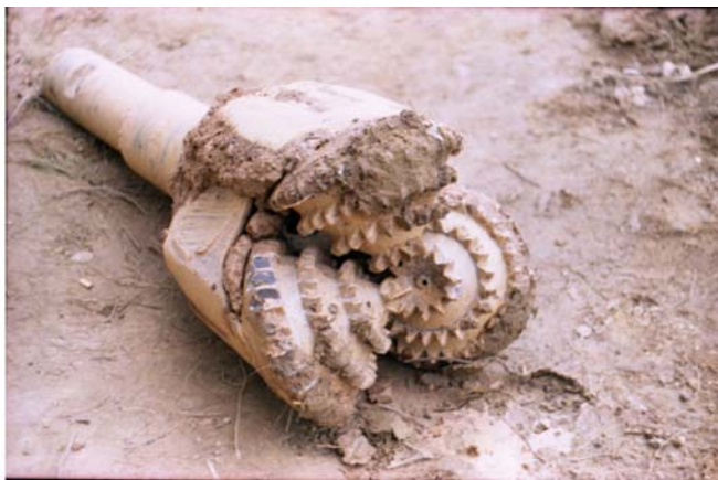
Εικόνα 21 . Τρίκωνο γκραναζωτό χαλύβδινο , διαμέτρου 19 ½ ιντσών
