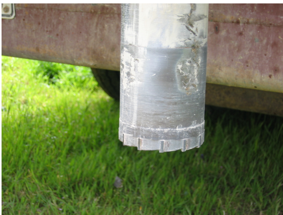
Εικόνα 3 . Βιδιοκορώνα, με διάμετρο 113 mm, στην οποία είναι βιδωμένη η καροταρία
