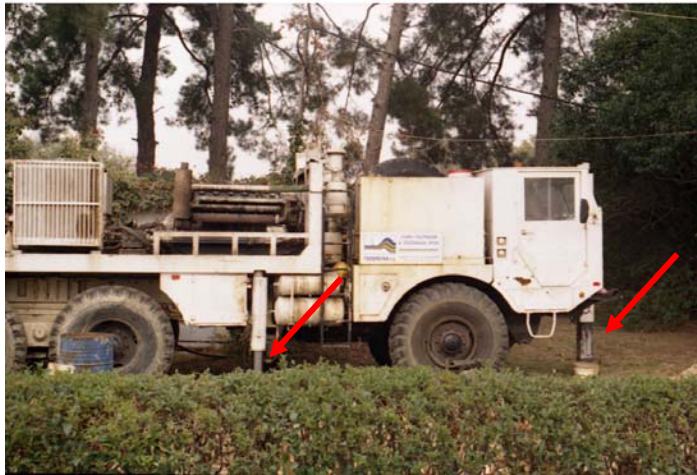
Εικόνα 12 . Ειδικά «πόδια» που βρίσκονται περιμετρικά του φορτηγού και βοηθούν στην οριζοντίωση & ευθυγράμμιση του
