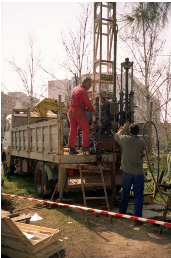
Εικόνα 5. Εκτέλεση δοκιμής Terzaghi (SPT), με την ελεύθερη πτώση σφύρας
