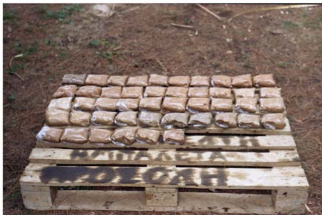
Εικόνα 20 . Δείγματα σχηματισμών της γεώτρησης, τοποθετημένα μέσα σε σακουλάκια
