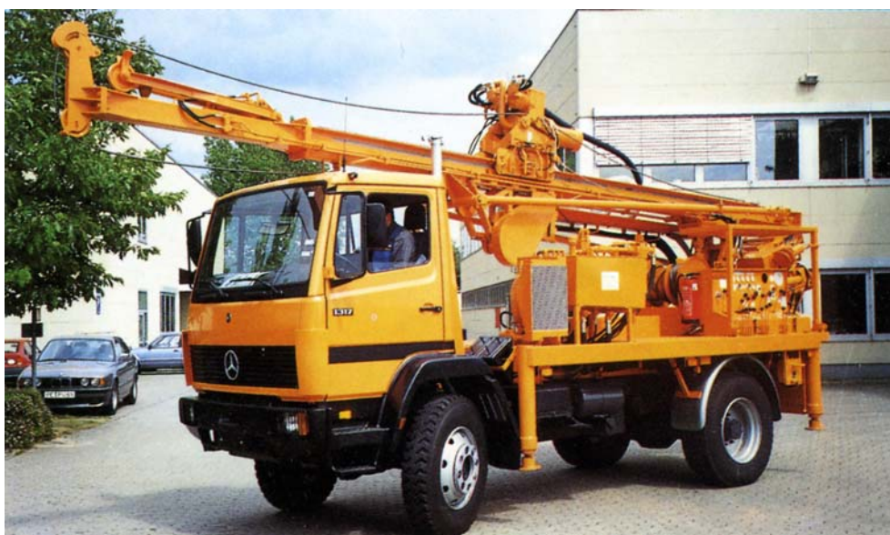
Σχήμα 2α. Σύγχρονο δειγματοληπτικό γεωτρύπανο τοποθετημένο πάνω σε αυτοκινούμενο όχημα
