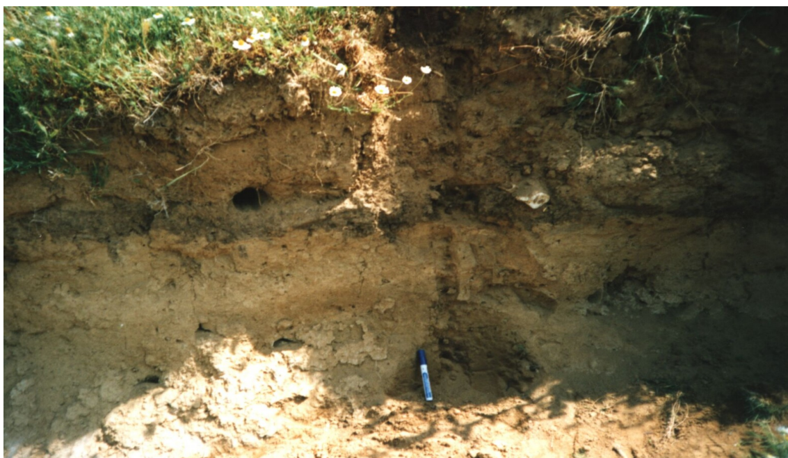
Φωτ. 10. Τρόπος και θέση δειγματοληψίας (37) κοντά στην κοίτη του Φιλιούρη ποταμού, με άνοιγμα μικρού λάκου
