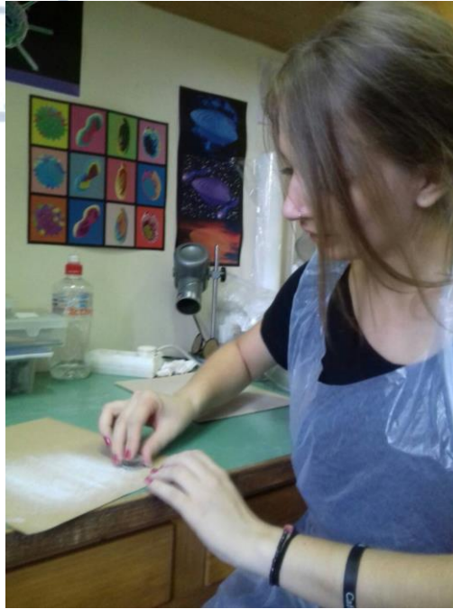
Εικόνα 24. Στάδιο λείανσης στιλπνών τομών (φωτο Ζ. Κυνηγοπούλου).
