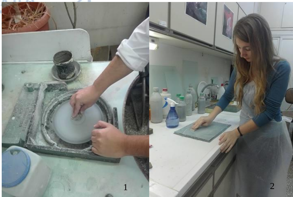
Εικόνα 22. Απεικόνιση σταδίων λείανσης, 1: στάδιο τροχού, 2: στάδιο γυαλόχαρτων, (φωτο Σ. Γεωργίου).
