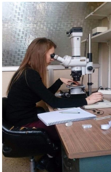
Εικόνα 25. Πραγματοποίηση μορφομετρικών μετρήσεων σε ορθοσκόπιο τύπου Wild Photomakroskop M400.
