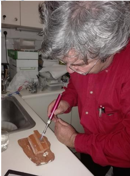
Εικόνα 23. Στάδιο πυράκτωσης του Νουμμουλίτη (φωτο Σ. Γεωργίου).
