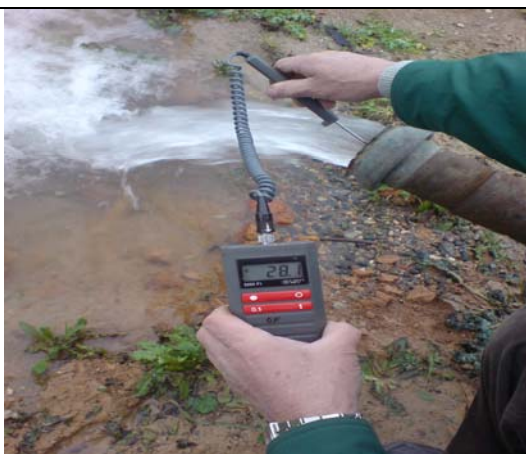
Μετρήσεις θερμοκρασίας κατά την άντληση (Πηγή:Προσωπικό αρχείο)
