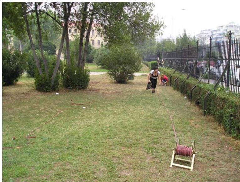
Εικόνα 3.2.2. Το καλώδιο μεγάλου μήκους μέσω του οποίου τροφοδοτήσαμε τα ηλεκτρόδια με τεχνητά παραγόμενο ηλεκτρικό ρεύμα.
