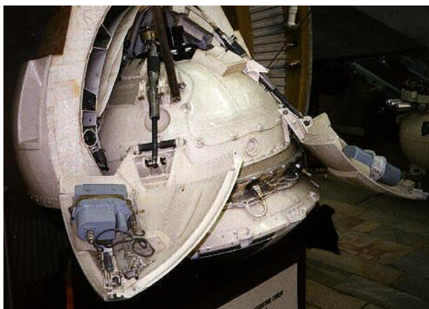
Φωτ. 6 Στην εικόνα φαίνεται η κάμouλα, που έφεραν τα διαστημικά λεωφορεία των αποστολών Mars 2-3, που θα προσεδάφιζονταν στην επιφάνεια του πλανήτη, στην πρώτη προσπάθεια που είχε γίνει μέχρι τότε, ώστε να γίνει μελέτη του πλανήτη Άρη από ένα επιφανειακό όχημα εξερεύνησης.
