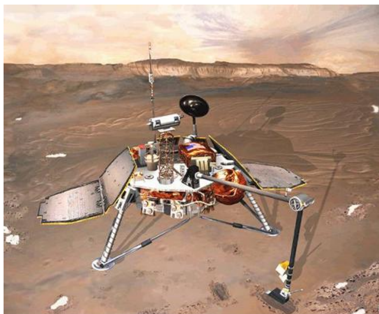
Εικ. 8 Αυτή θα έπρεπε να είναι η κατάληξη του Mars Polar Lander στην περιοχή του νότιου πόλου του πλανήτη Άρη. Κάτι τέτοιο βέβαια δε συνέβη ποτέ, αφού τόσο το Mars Polar Lander, όσο και τα δύο microprobes τα οποία μετέφερε, συνετρίβησαν, για άγνωστους λόγους, στην επιφάνεια του πλανήτη.
