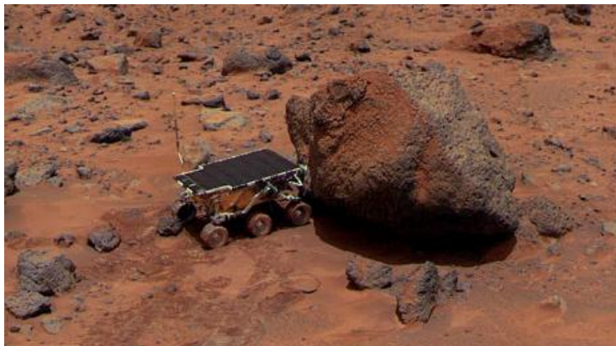
Φωτ. 13 Το διαστημικό όχημα εξερεύνησης Sojourner κάνει μία δειγματοληψία στον περήγμο Yogi Rock (βράχος του Yogi) και μετέπειτα θα αναλύσει το εδαφικό δείγμα με το Alpha Proton X-ray Spectrometer. Ο βράχος αυτός ήταν κοντά στο σημείο προσεδάφισης της μονάδας του Mars Pathfinder και η ανάλυσή του πετρώματος έδειξε ότι έχει σύσταση ανάλογη με τους βασάλτες.
