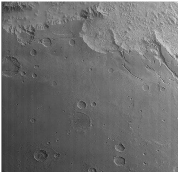
Φωτ. 23 Η φωτογραφία αυτή είναι το πρώτο δείγμα της Context Camera η οποία τραβάει ασπρόμαυρες φωτογραφίες κλίμακας 6km/pixel. Πάρθηκε κατά το 10 πέρασμα του δορυφόρου γύρω από τον πλανήτη στις 24 Μαρτίου 2005 με σκοπό να φανεί η κατάσταση της συσκευής και να γίνει νομοθέτηση (calibration). Η περιοχή φαίνεται να είναι χαοτική όσον αφορά το ανάγλυφο, βρίσκεται ανατολικά της κοιλάδας Valles Marineris και η ευκρίνεια της φωτογραφίας είναι μόλις 87km/pixel σχεδόν 14,5 φορές μικρότερη από αυτή που θα χρησιμοποιηθεί κατά το κύριο μέρος της αποστολής, αν και ο κύριος σκοπός της camera θα είναι να φωτογραφίζονται περιοχές μήκους 30km και στην ουσία να δημιουργούνται μικροί χάρτες της επιφάνειας του πλανήτη.
