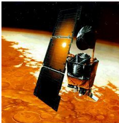
Εικ. 7 Εικαστική απεικόνιση του δορυφόρου Mars Climate Orbiter σε τροχιά γύρω από τον πλανήτη Άρη. Κάτι τέτοιο δεν έγινε ποτέ, αφού η επικοινωνία με αυτό διεκόπη, πιθανότατα λόγω εισαγωγής λάθος δεδομένων στο σύστημα πλοήγησης του διαστημοπλοίου. Ο Mars Climate Orbiter τελικά εισήλθε στην ατμόσφαιρα του πλανήτη και καταστράφηκε. Ήταν μία μεγάλη αποτυχία, αφού η αποστολή θα υποστήριζε μελλοντικές αποστολές που είχαν προγραμματιστεί να γίνουν προς τον πλανήτη.
