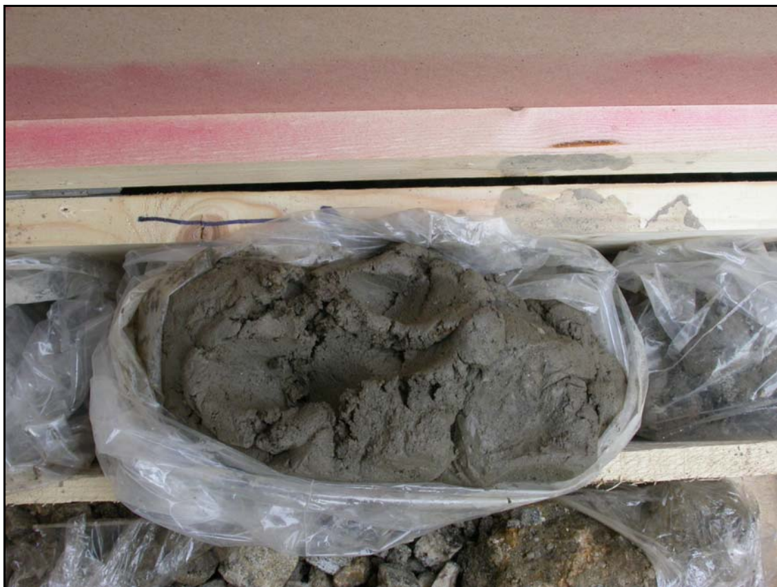
Εικόνα 7.8. Εδαφικό υλικό πάχους (προϊόν αποσάθρωσης) 5m σε βάθος 25m. Γεώτρηση ΓΣ4
