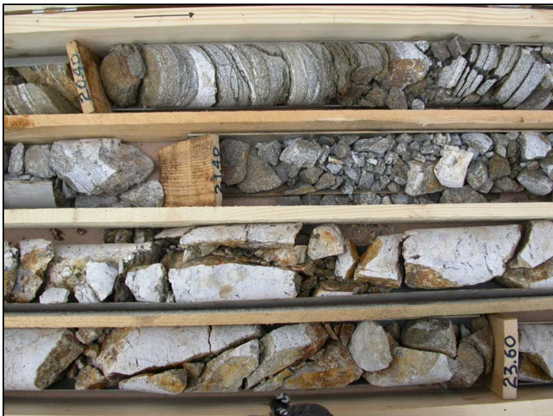
Εικόνα 7.9. Εμφανής κατακερματισμός της βραχομάζας σε βάθος 22-24 m. Γεώτρηση ΓΣ 1.
