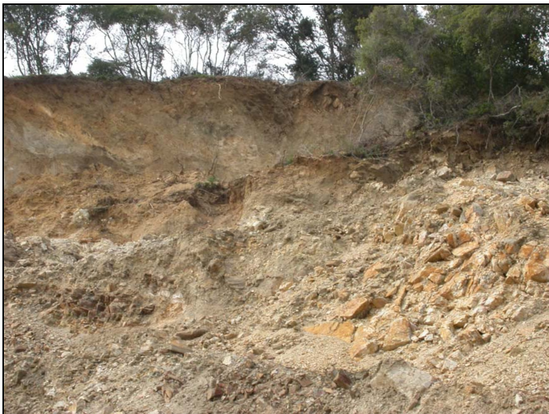
Εικόνα 7.6. Εμφανής η απεικόνιση της στέψης και της κύριας πτώσης της κατολίσθησης.
