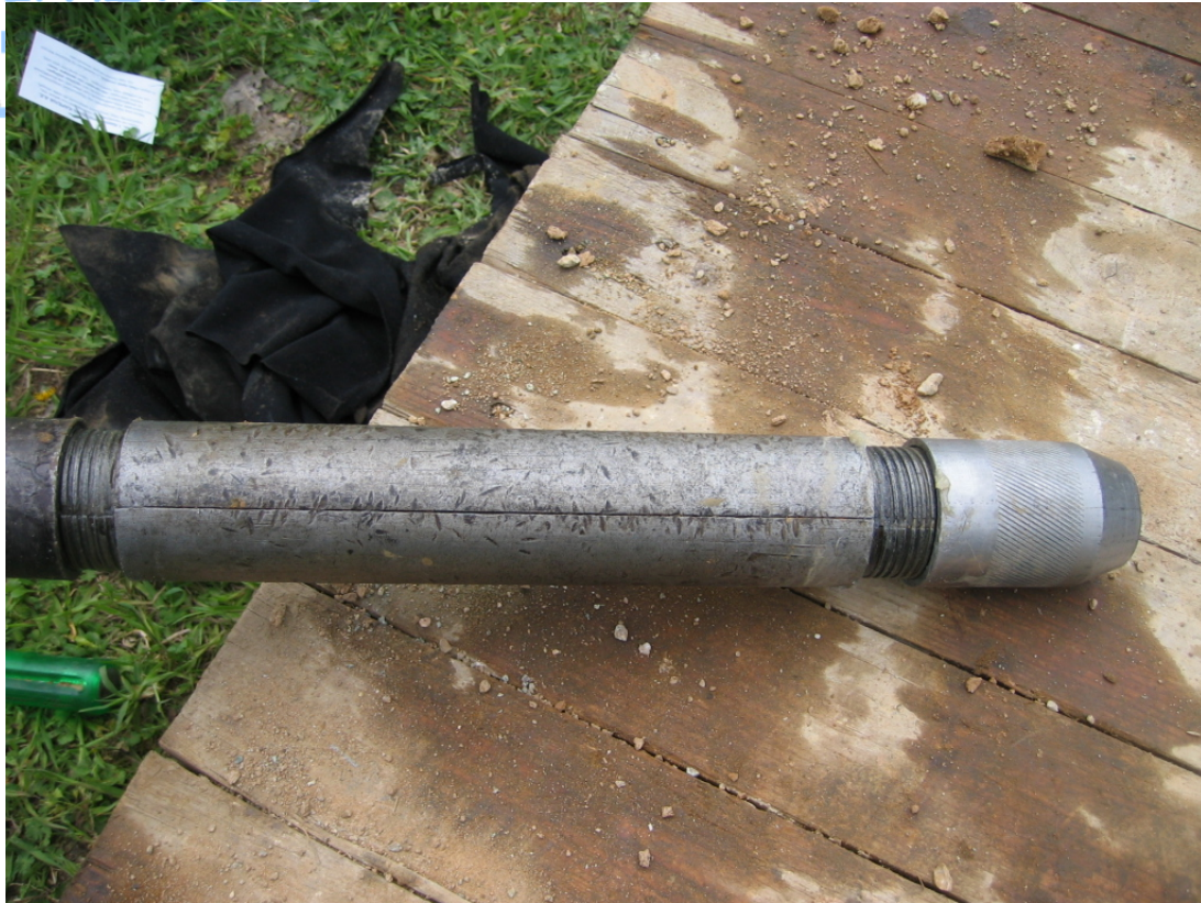
Εικόνα 12. Πρότυπος διαιρετός δειγματολήπτης Terzaghi
