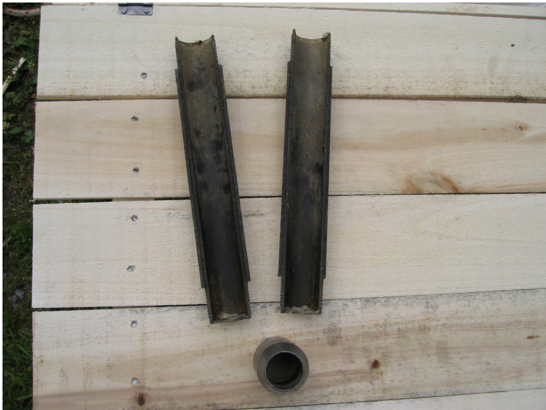
Εικόνα 13. Πρότυπος διαιρετός δειγματολήπτης Terzaghi (σε ανάλυση)
