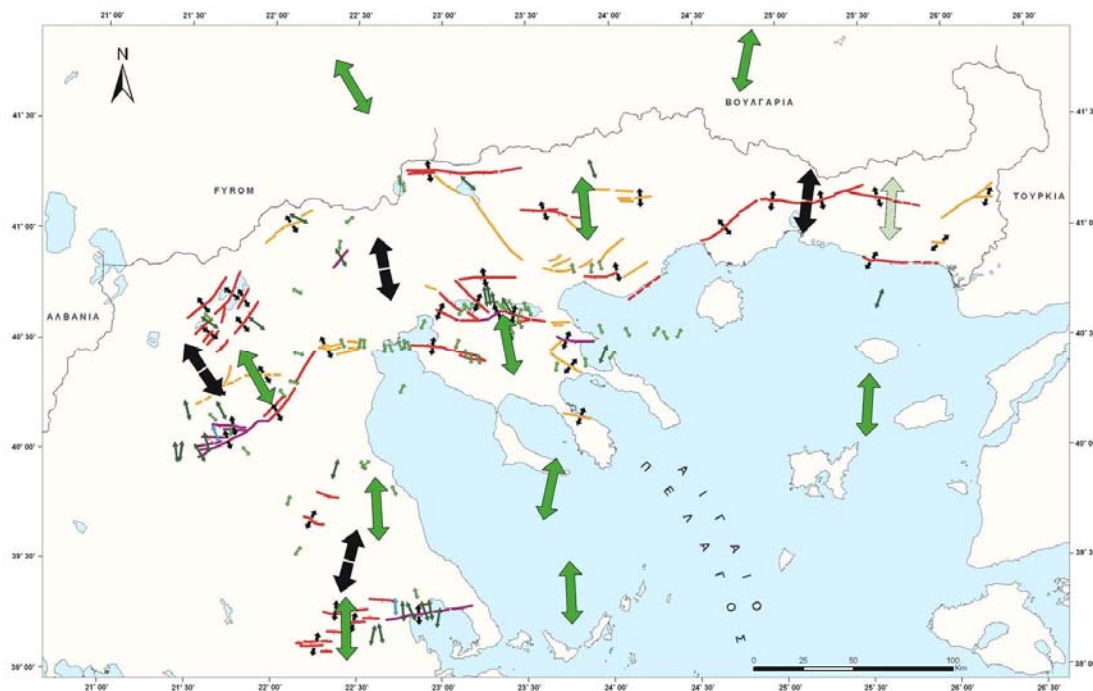
Σχήμα 2.9. Χάρτης με τα μεγάλα ενεργά ρήγματα του Βόρειου Ελληνικού Χώρου, και τις διευθύνσεις των εφελκυστικών τάσεων που υπολογίστηκαν από σεισμολογικά δεδομένα (πράσινα βέλη) και από τεκτονικές μετρήσεις (μαύρα βέλη). (Μουντράκης, 1988)
