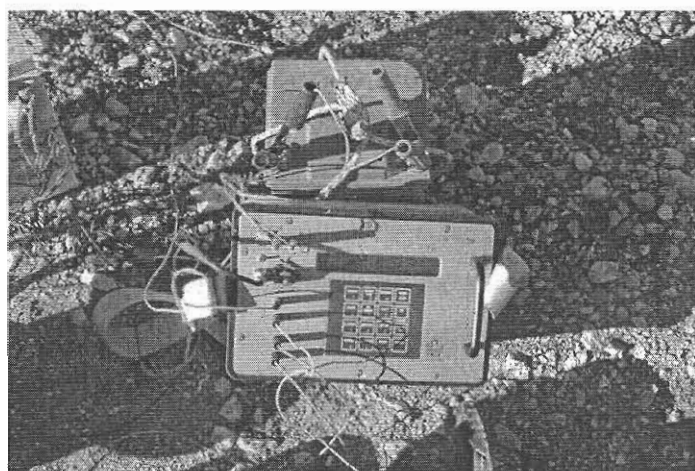
Σχήμα 2.5.: Όργανο λήψης ηλεκτρικών μετρήσεων SYSCAL (V11.4++) της εταιρείας IRIS INSTRUMENTS (επάνω). Ο εξοπλισμός με τη συνδεσμολογία που χρησιμοποιήθηκε κατά τη διάρκεια της μέτρησης (κάτω).
