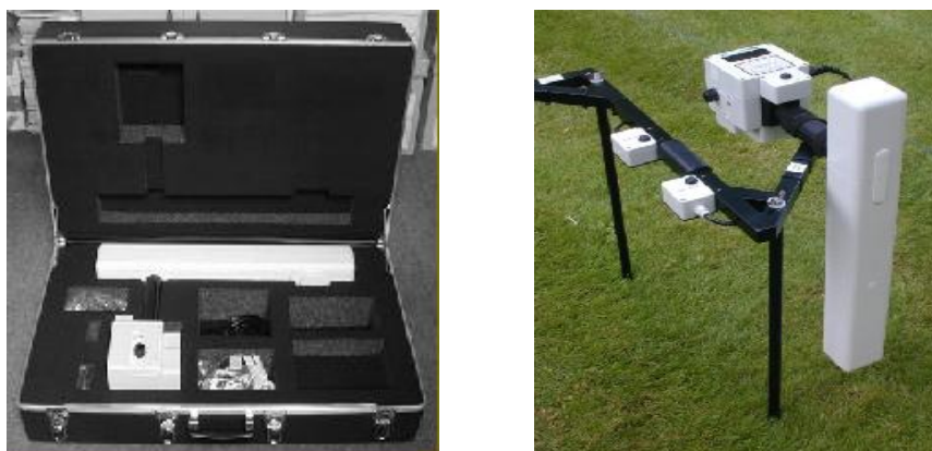
Σχήμα 3.5 Αποψη του διαφορικού μαγνητομέτρου ρυθμιζόμενης μαγνητικής ροής ροής (Geoscan FM256 - Fluxgate Gradiometer).
