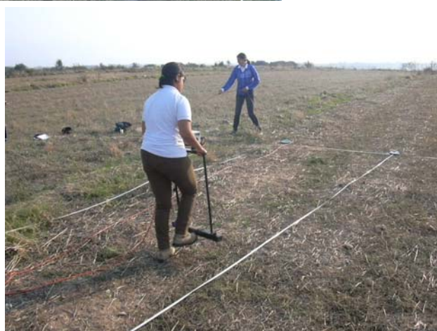
Σχήμα 3.1 Το όργανο μέτρησης Rm15 της εταιρείας Geoscan Research και το συνεργείο κατά την πραγματοποίηση ηλεκτρικών μετρήσεων στη περιοχή της Απολλωνίας
