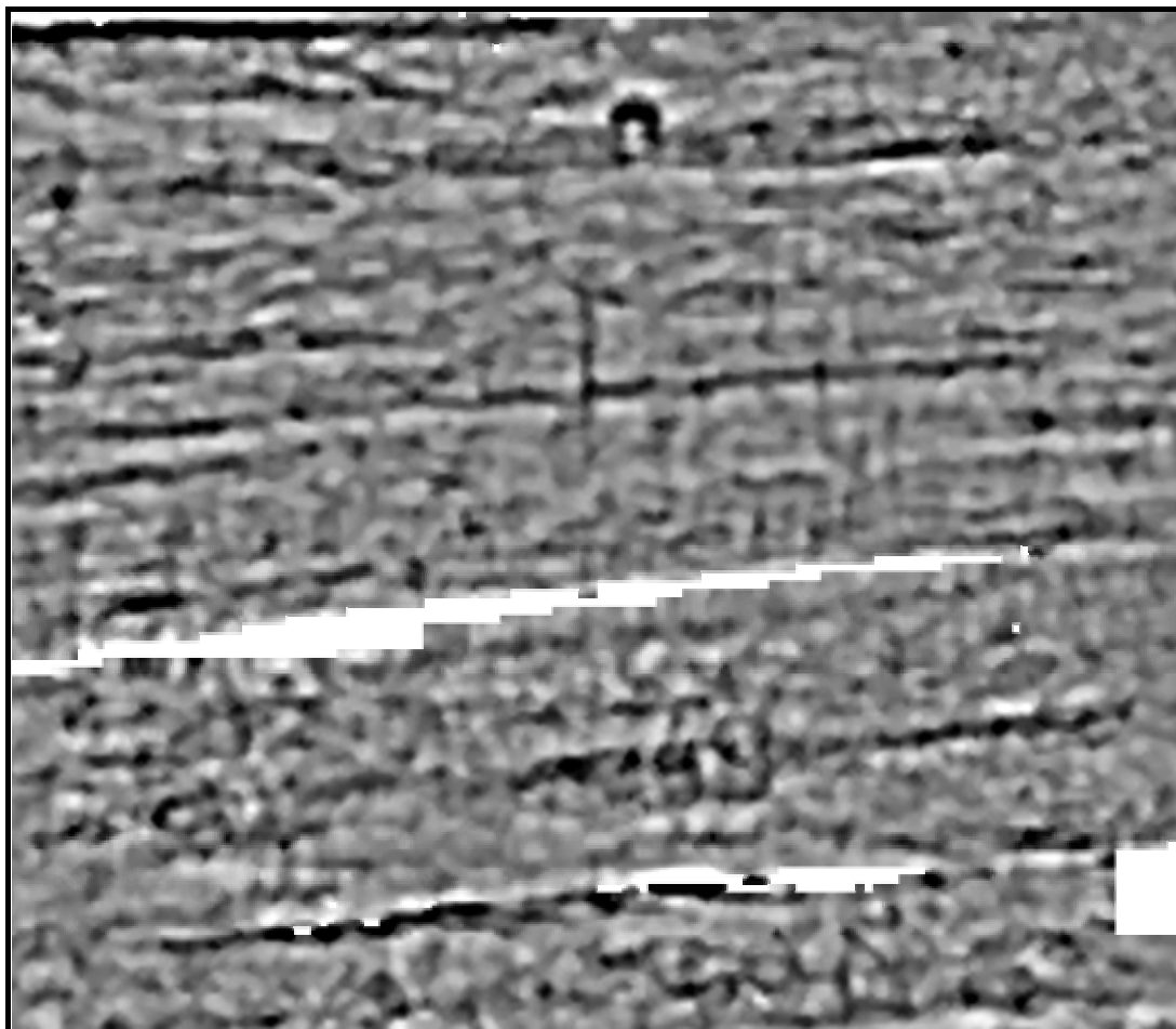
Σχήμα 4.9 Αποτέλεσμα συνδυασμού επεξεργασιών στα «δεδομένα βάσης». Συγκεκριμένα εφαρμόστηκε φίλτρο γεωμετρικού μέσου, έγινε κατόπιν παρεμβολή και τελικά εφαρμόστηκε φίλτρο διέλευσης υψηλών συχνοτήτων.
