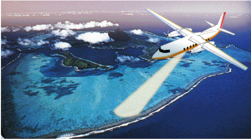
Εικόνα Β. 4. Τρόπος απεικόνισης με αερομεταφερόμενο ραντάρ πλευρικής κάλυψης (SLAR) ( http://earth.esa.int ).
