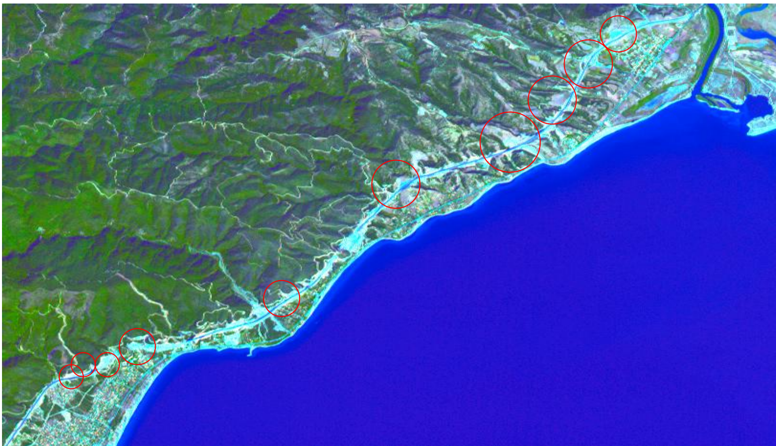
Εικ. 12: Σύνθεση ψευδοέγχρωμης εικόνας (PCA3, PCA1, PCA2) : RGB του TERRA / ASTER, η οποία προέκυψε από τις εικόνες «κυρίων συνιστωσών» των φασματικών ζωνών του ASTER που λήφθηκε στις 11/10/2003. Οι θέσεις 1 – 10, στις οποίες έχουν εκδηλωθεί κατολισθήσεις, έχουν σημειωθεί με κύκλους από αριστερά προς τα δεξιά.
