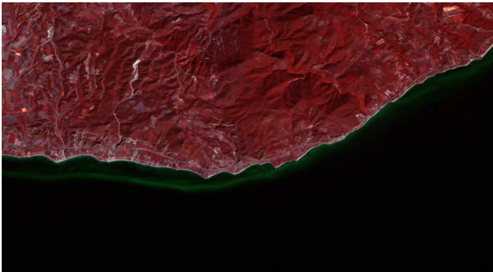
Εικ. 6 : Ψευδοέγχρωμη εικόνα (3,1,2) : RGB, του TERRA / ASTER, η οποία λήφθηκε στις 11/10/2003. Στην εικόνα αυτή απεικονίζεται η περιοχή των Λουτρών Ελευθερών, στην οποία δεν μπορούμε να διακρίνουμε θέσεις στις οποίες έχουν εκδηλωθεί κατολισθήσεις.
