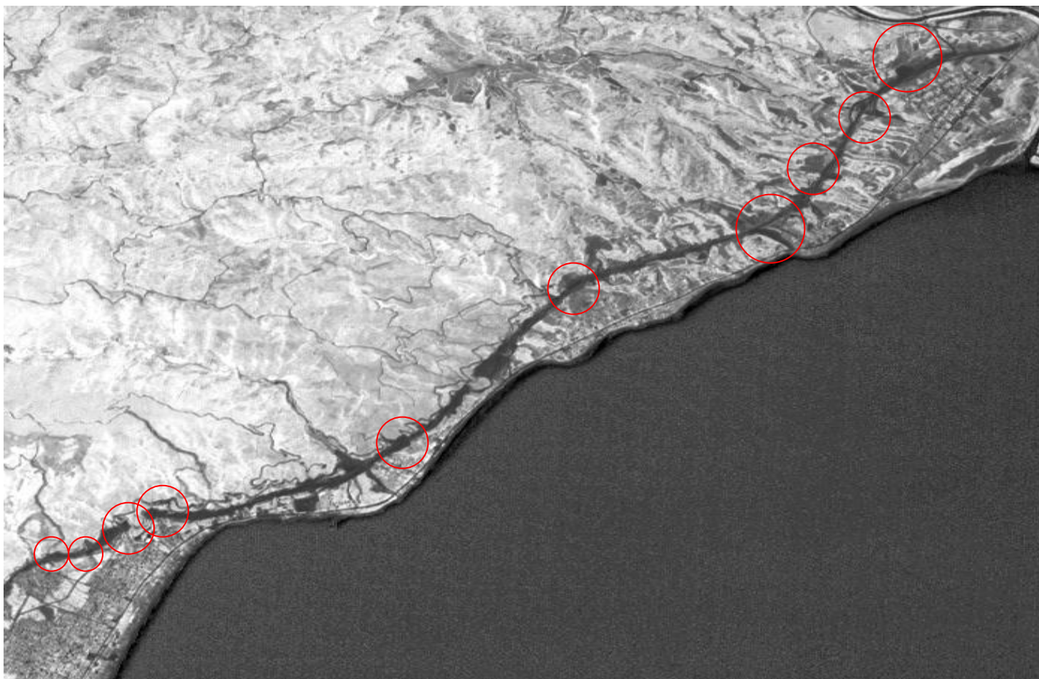
Εικ. 14 : Εικόνα NDVI, του TERRA / ASTER στις 11/10/2003. Οι περιοχές στις οποίες έχουν εκδηλωθεί κατολισθήσεις απεικονίζονται με χαρακτηριστικούς σκοτεινούς τόνους του τεφρού χρώματος και έχουν σημειωθεί με κόκκινους κύκλους.
