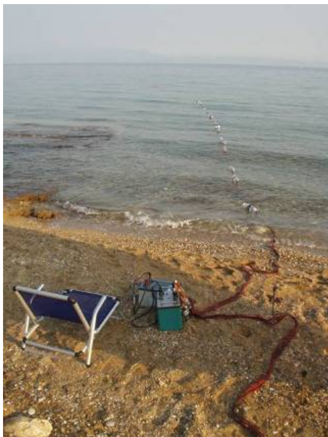
Σχήμα 6.7 Τοποθέτηση του καλωδίου στην επιφάνεια της θάλασσας και στην ακτή.
