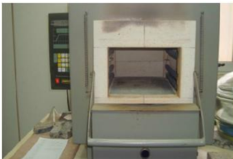
Εικόνα 3.2. Φούρνος για τη μέτρηση της απώλειας πύρωσης του Τομέα Ορυκτολογίας-Πετρολογίας-Κοιτασματολογίας του Α.Π.Θ.
