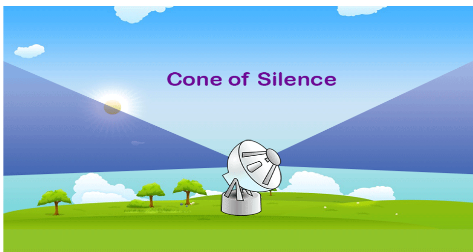
Σχήμα 2.2: Μετεωρολογικό ραντάρ και απεικόνιση της περιοχής του κώνου της σιωπής (Μπαμπζέλης, 2013).
