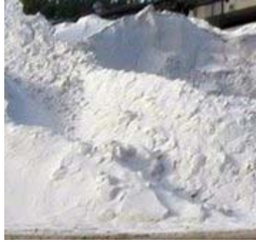
Φωτ. 8. Χαλαζιακή άμμος ως κύρια πρώτη ύλη για την παραγωγή γυαλιού.
