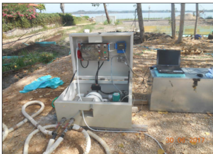
Εικόνα 4.11: Η διάταξη για το Geothermal Response Test (GeRT)
