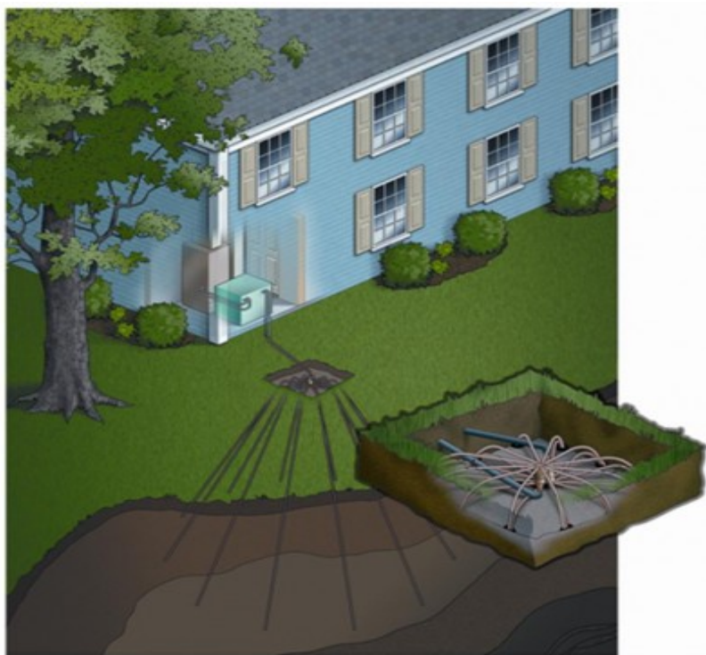
Εικόνα 3.20 Σύστημα άμεσης εκτόνωσης (Πηγή: http://geothermalvalley.com/about_geothermal.php )
