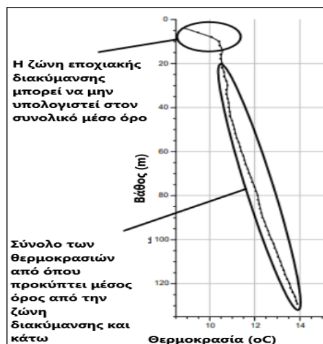
Εικόνα 4.10 Θερμοκρασία του εδάφους πριν την δοκιμή TRT (Τροποποιημένο από Marc Sauer et al., 2012 )
