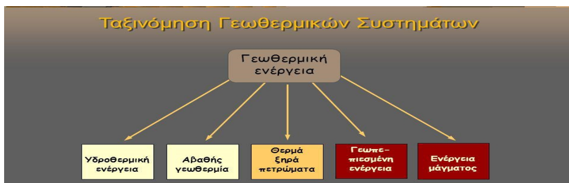
Εικόνα 1.2 Σχηματική απεικόνιση ταξινόμησης γεωθερμικών συστημάτων (Φυτίκας & Ανδρίτσος, 2004)
