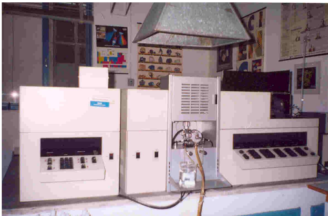
Φωτ.4.1: Φασματοφωτόμετρο Perkin Elmer 5000 του τομέα Ο.Π.Κ.
