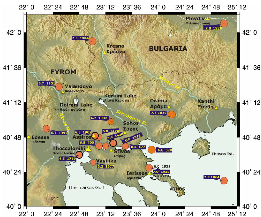
Σχήμα 3.3. Ιστορικοί και σεισμοί του παρόντα αιώνα (στοιχεία από Παπαζάχος και Παπαζάχου, 2003) που επηρέασαν την πόλη της Θεσσαλονίκης. Τα επίκεντρα των σεισμών συμβολίζονται με κύκλους και δίπλα σε κάθε επίκεντρο φαίνεται το μέγεθος του σεισμού και το έτος γένεσης. Όπως διαπιστώνεται αυτοί προέρχονται είτε από κοντινές και ενδιάμεσες αποστάσεις αλλά και από αποστάσεις εκατοντάδων χιλιομέτρων μακριά από την πόλη (για παράδειγμα σεισμός της Φιλιππούπολης 1928. Η απόσταση και το συχνοτικό περιεχόμενο της μέγιστης εδαφικής κίνησης καθορίζει ποιο τμήμα του πολεοδομικού ιστού θα υποστεί βλάβες.
