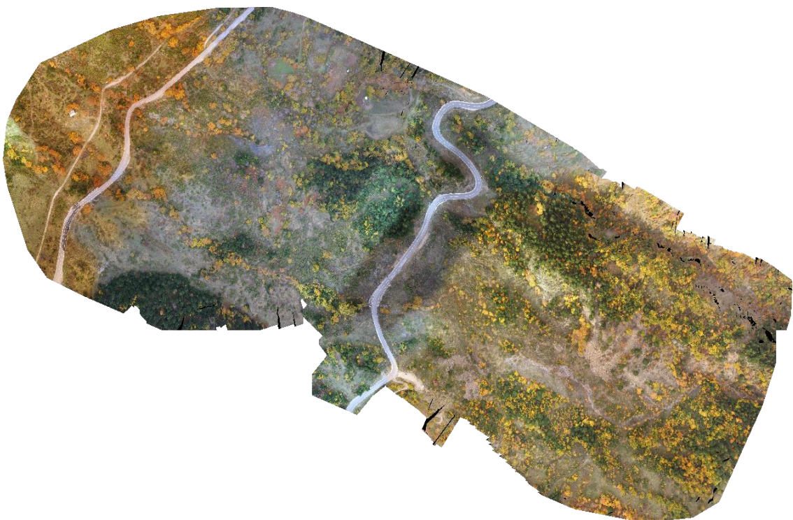
Εικόνα 10: Ορθομωσαϊκό της κατολίσθησης, προέκυψε από την επεξεργασία των εικόνων του UAV.
