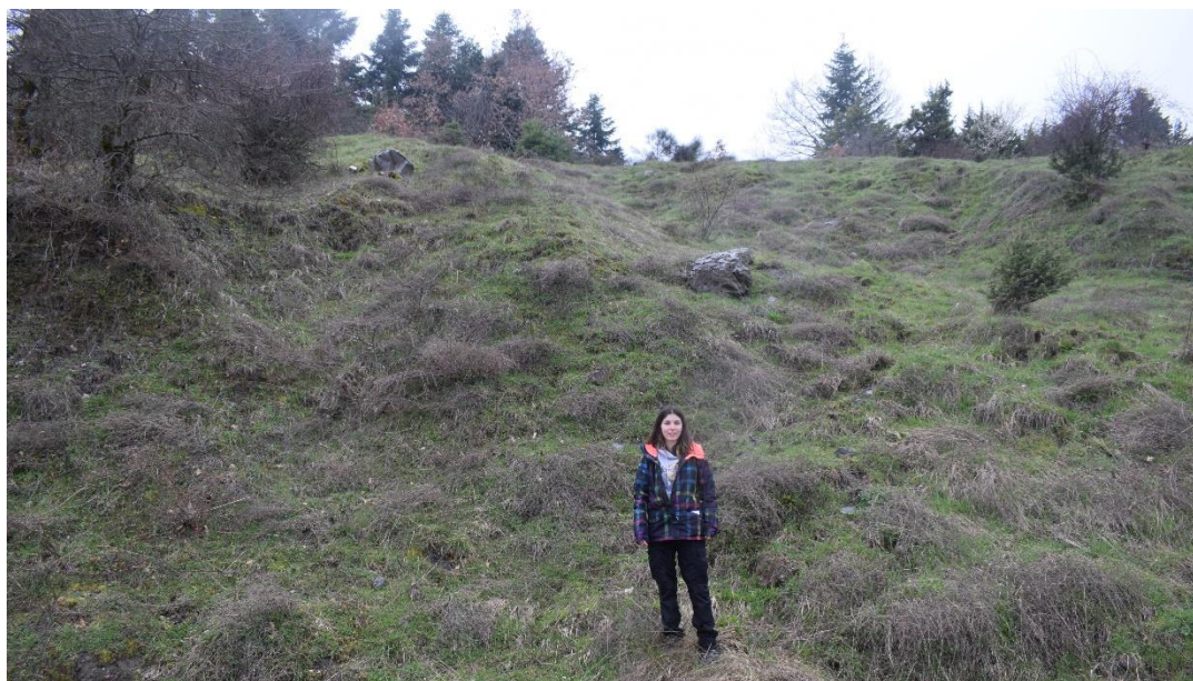
Εικόνα 4: Τυπική μορφή κατολισθήσεων, βυθίσματα και φουσκώματα, φωτογραφία τραβηγμένη στις 25-3-2018.
