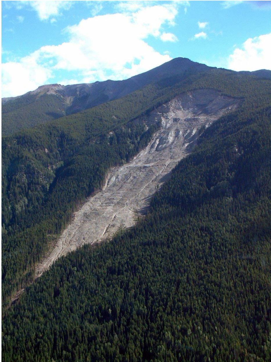
Φωτο 3.12: Σύνθετη μετακίνηση (composite slide), αποτελούμενη από πτώση από ανατροπή (rock topple) και ροή κορημάτων (debris flow). ( http://cgc.rncan.gc.ca/landslides ).
