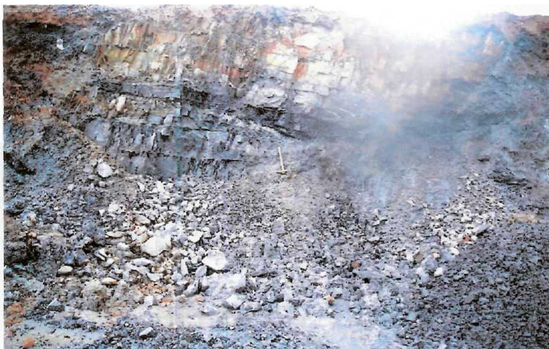
Φωτ. 8: Περιοχή κοίτης. Το επάνω επίπεδο (ταμπάνι) είναι σε υψόμετρο ~135,0m και το κάτω σε υψόμετρο ~131,0m Χαλαζίτες με ενστρώσεις μαύρου γραφικού σχιστόλιθου. Δημιουργείται ανοιχτό αντίκλινο. (Λήψη φωτογραφίας στις 02-05-2006).
