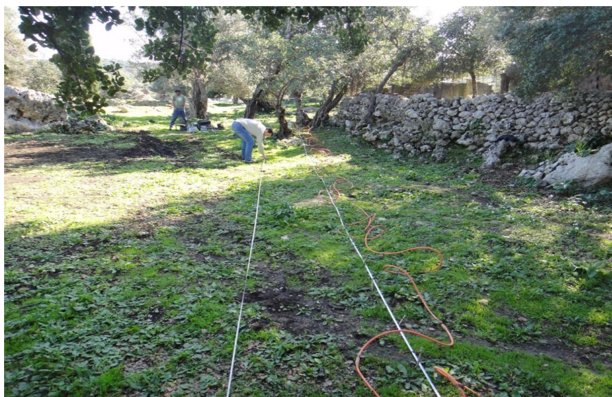
Σχήμα 5.5. πεδίο έρευνας και τοποθέτηση του πολύκλωνου καλωδίου
