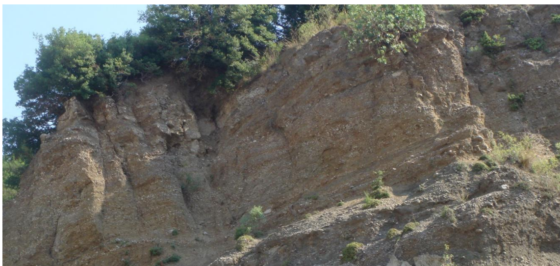
Φωτογραφία 6.1. Επιφανειακή εμφάνιση κροκαλοπαγούς, όπου είναι εμφανής η έντονη στρωσιγένεια καθώς και το παρακατακόρυφο σύστημα διακλάσεων που διατρέχει τη μάζα του
