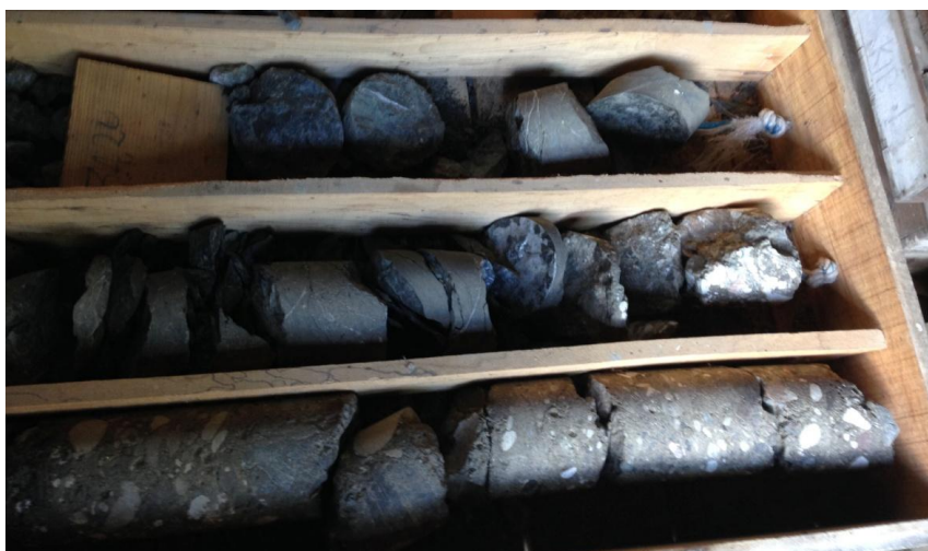
Φωτογραφία 4.1. Πυρήνας δειγματοληψίας από γεώτρηση στην περιοχή του φρέατος ανάπαλσης (MB-4) όπου απεικονίζεται ιλυολίθος σε επαφή με κροκαλοπαγές
