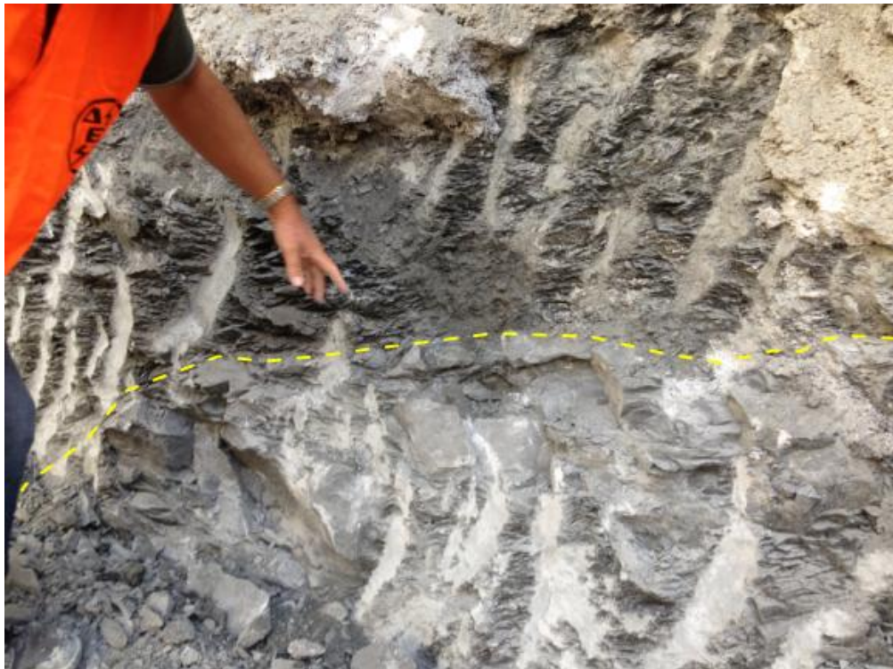
Φωτογραφία 4.10. Επώθηση της πινδικής ενότητας πάνω στην Ιόνια (περιοχή φρέατος ανάπαλσης, βάθος 10 m περίπου)
