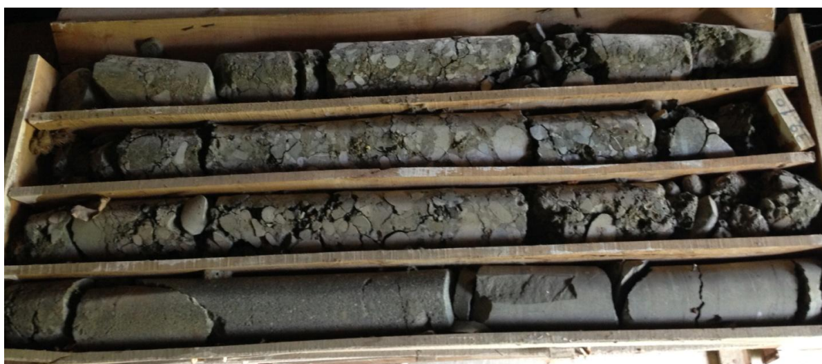
Φωτογραφία 4.4. Μετάβαση κροκαλοπαγούς σε χονδρόκοκκο ψαμμίτη και βαθμιαία σε συμπαγή ιλυούχο ψαμμίτη (γεώτρηση ΜΕ/ΣΤ-3)
