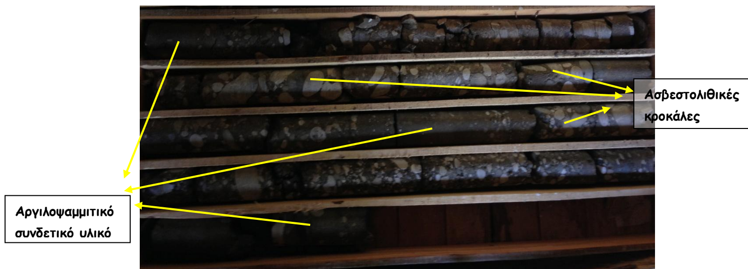
Φωτογραφία 4.7. Πυρήνας δειγματοληψίας που αντιστοιχεί στο σκληρό πολύμκτο μαζικό κροκαλοπαγές
