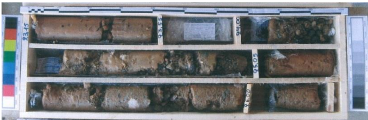
Εικόνα 4.9. Τεταρτογενείς αποθέσεις, γεώτρηση ΤΑΕΡ24 στην περιοχή του Νέου Σιδηροδρομικού Σταθμού. Περιγραφή: Σταθερή, έως στιφρή, καστανή, αμμώδης ισχνή ΑΡΓΙΛΟΣ με χάλικες, έως αργιλώδης ΑΜΜΟΣ με χάλικες (από Μετρό Θεσσαλονίκης).
