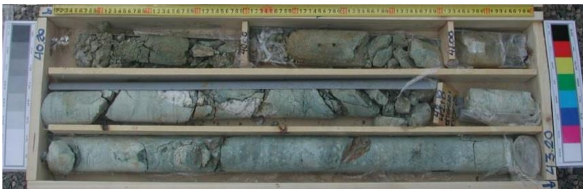
Εικόνα 4.34. Ενότητα Χορτιάτη, γεώτρηση TDSP25 στην περιοχή Αγ. Σοφία. Περιγραφή: Ασθενής έως ισχυρός, γκριζοπράσινος γενύσιος ελαφρά αποσαθρωμένος, μέτρια κερματισμένος, οξειδωμένος στις επιφάνειες ασυνέχειας (από Μετρό Θεσσαλονίκης).
