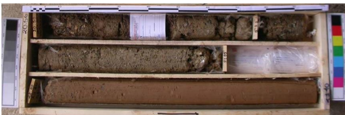
Εικόνα 4.10. Τεταρτογενείς αποθέσεις, γεώτρηση ΤΚΣΡ21 στην περιοχή Αναλήψεως. Περιγραφή: Πυκνή, καστανοπράσινη, αργιλώδης ΑΜΜΟΣ με λεπτά μεσαία χαλίκια μικρής πλαστικότητας έως ΑΜΜΟΣ καλής διαβάθμισης με ιλύ και μεσαία χαλίκια γενεσιακής προέλευσης, χωρίς πλαστικότητα (από Μετρό Θεσσαλονίκης).
