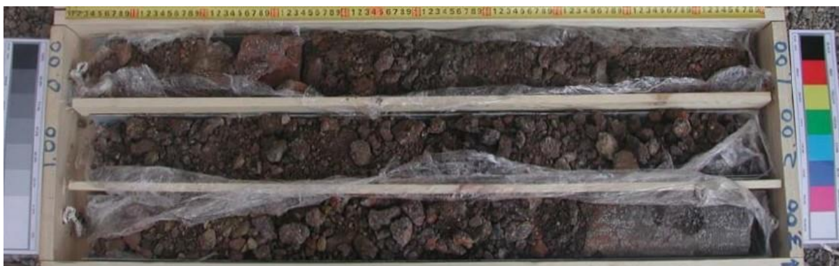
Εικόνα 4.2. Τεχνητές επιχώσεις, γεώτρηση TDS25 στην περιοχή Αγ. Σοφίας. Περιγραφή: πολύ χαλαροί έως χαλαροί, μέτρια πυκνοί, καστανού έως σκούρου καστανού χρώματος, ΧΑΛΙΚΕΣ κακής διαβάθμισης με ιλύ και άμμο, χωρίς πλαστικότητα, με θραύσματα και τούβλα (από Μετρό Θεσσαλονίκης).
