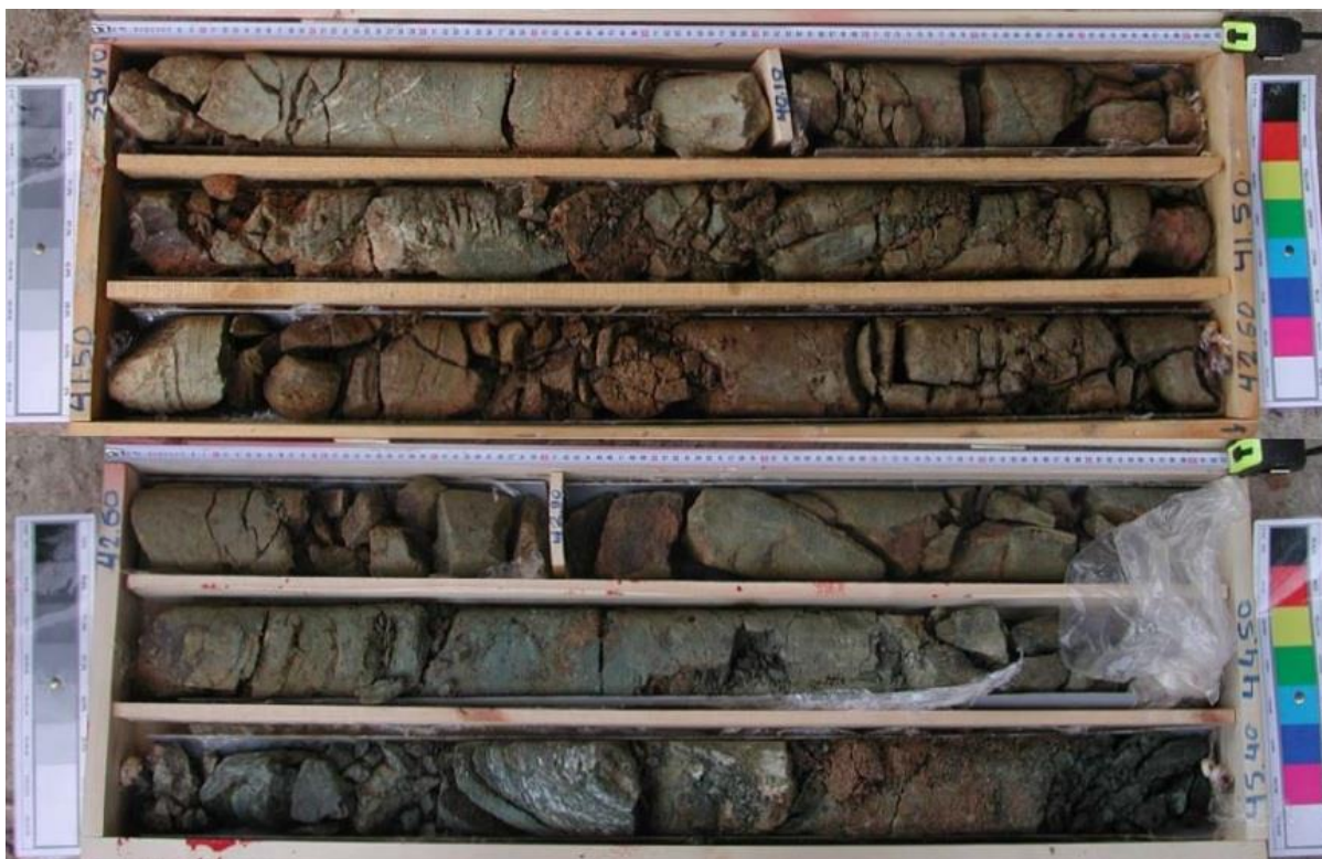
Εικόνα 4.33. Ενότητα Χορτιάτη, γεώτρηση TDSP22 στην περιοχή Αγ. Σοφία. Περιγραφή: Πρασινωπού χρώματος γενύσιος, κερματισμένος, οξειδωμένος με παρουσία χαλαζιακών φλεβών. (από Μετρό Θεσσαλονίκης).
