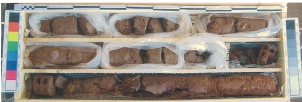
Εικόνα 4.3. Τεχνητές επιχώσεις, γεώτρηση TF22 στην περιοχή Συντριβάνι. Περιγραφή: ΑΜΜΟΣ με τούβλα, φυτικά και κροκάλες πρασινοσχιστολιθικής και χαλαζιακής προέλευσης (από Μετρό Θεσσαλονίκης).
