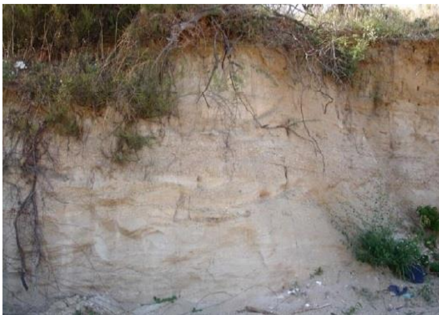
Εικόνα 3.15. Διασταυρούμενες στρώσεις άμμων και αργίλου σε τομή Ψαμμιτομαργαϊκής σειράς Νεογενών αποθέσεων, στην περιοχή της Περαίας. (Ζερβοπούλου, 2010)
