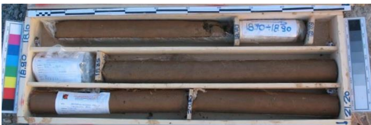
Εικόνα 4.11. Τεταρτογενείς αποθέσεις, γεώτρηση ΤΜΤΡ26 στην περιοχή Πατρικίου-Βούλγαρη. Περιγραφή: Στιφρή έως σταθερή, καστανή ισχνή ΑΡΓΙΛΟΣ με λεπτόκοκκη άμμο, μικρής έως μέσης πλαστικότητας (από Μετρό Θεσσαλονίκης).
