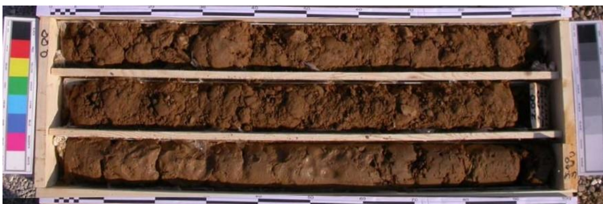
Εικόνα 4.4. Τεχνητές επιχώσεις, γεώτρηση TK26 στην περιοχή Φλέμινγκ-Αναλήψεως. Περιγραφή: Σταθερή, καστανή, αμμώδης ΙΛΥΣ με λεπτόκοκκη άμμο, έως ιλυώδης ΑΜΜΟΣ, χωρίς πλαστικότητα (από Μετρό Θεσσαλονίκης).
