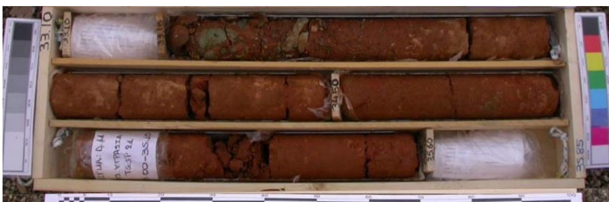
Εικόνα 4.22. Νεογενείς αποθέσεις (Ερυθρές άργιλοι), γεώτρηση TGSP21 στην περιοχή Πανεπιστήμιο. Περιγραφή: Σκληρή κόκκινη αμμώδης ισχνή ΑΡΓΙΛΟΣ μέσης πλαστικότητας με οξειδώσεις (διαποτισμοί) κόκκινου χρώματος και ασβεστίτικα συγκρίματα (από Μετρό Θεσσαλονίκης).
