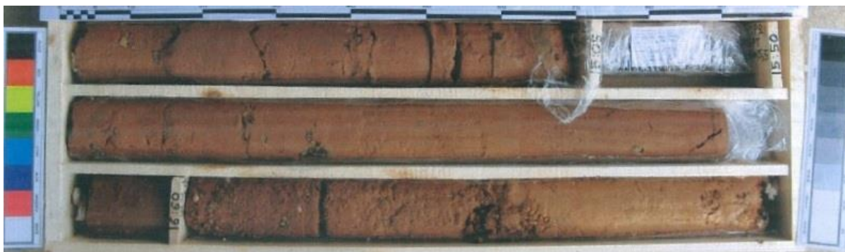
Εικόνα 4.21. Νεογενείς αποθέσεις (Ερυθρές άργιλοι), γεώτρηση TBCP21 στην περιοχή Δημοκρατίας. Περιγραφή: Σταθερή έως στιφρή, καστανέρυθρη αμμώδης ισχνή ΑΡΓΙΛΟΣ με διάσπαρτους χάλικες κυρίως σχιστολιθικής και χαλαζιακής προέλευσης. (από Μετρό Θεσσαλονίκης).
