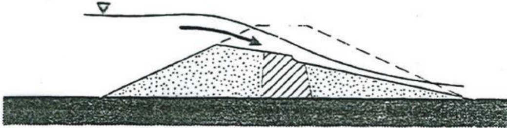
Σχήμα 17: Αστοχία τύπου υπερχείλισης
