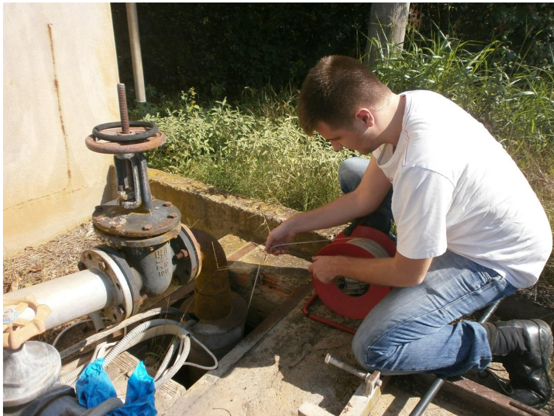
Σχήμα 9: Χαρακτηριστική φωτογραφία μέτρησης στάθμης υπογείων υδάτων ξηρής περιόδου, Οκτώβριος 2014
