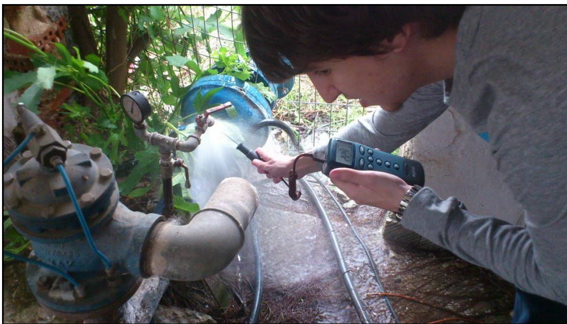
Εικόνα 10 : Φωτογραφία με τη μέτρηση της θερμοκρασίας του νερού στη γεώτρηση Χριστοφόρου της Νέας Ραιδεστού.
