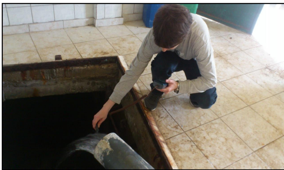
Εικόνα 3 : Φωτογραφία από τη διαδικασία μέτρησης του νερού της γεώτρησης Βονοφάκου με το ειδικό ηλεκτρονικό θερμόμετρο
