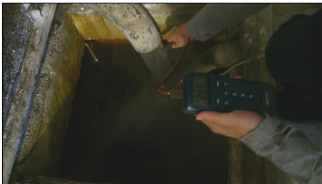
Εικόνα 8 : Φωτογραφία όπου απεικονίζεται η μέτρηση της θερμοκρασίας του νερού της γεώτρησης Γ25 και στο δεξιό σωλήνα έγινε μέτρηση της θερμοκρασίας του νερού της γεώτρησης Γ24
