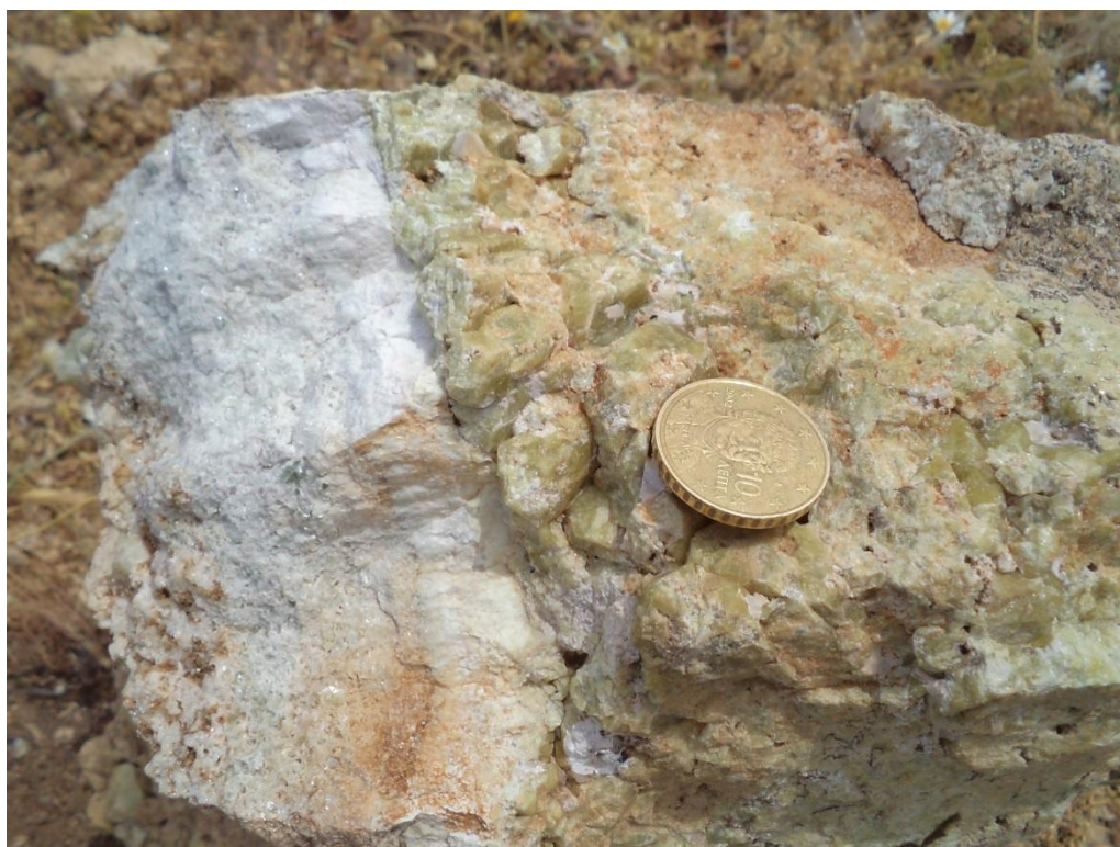
Εικόνα 5,1: Δείγμα μαρμαρυγιών από το skarn της Μαρώνειας. Στο λευκόσωμα διακρίνονται τα μικρά φυλλάκια που είναι μαρμαρυγίες, το οποίο βρίσκεται σε επαφή με γροσσουλάριο(γρανάτης που έχει ανοικτό πράσινο χρώμα).
