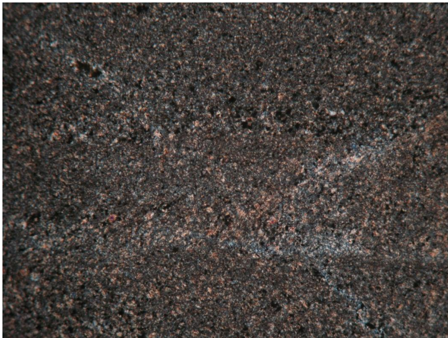
Σχ.6.9. Μικροκρυσταλλικός χαλαζίας με χαρακτηριστικές μικροδιακλάσεις.
