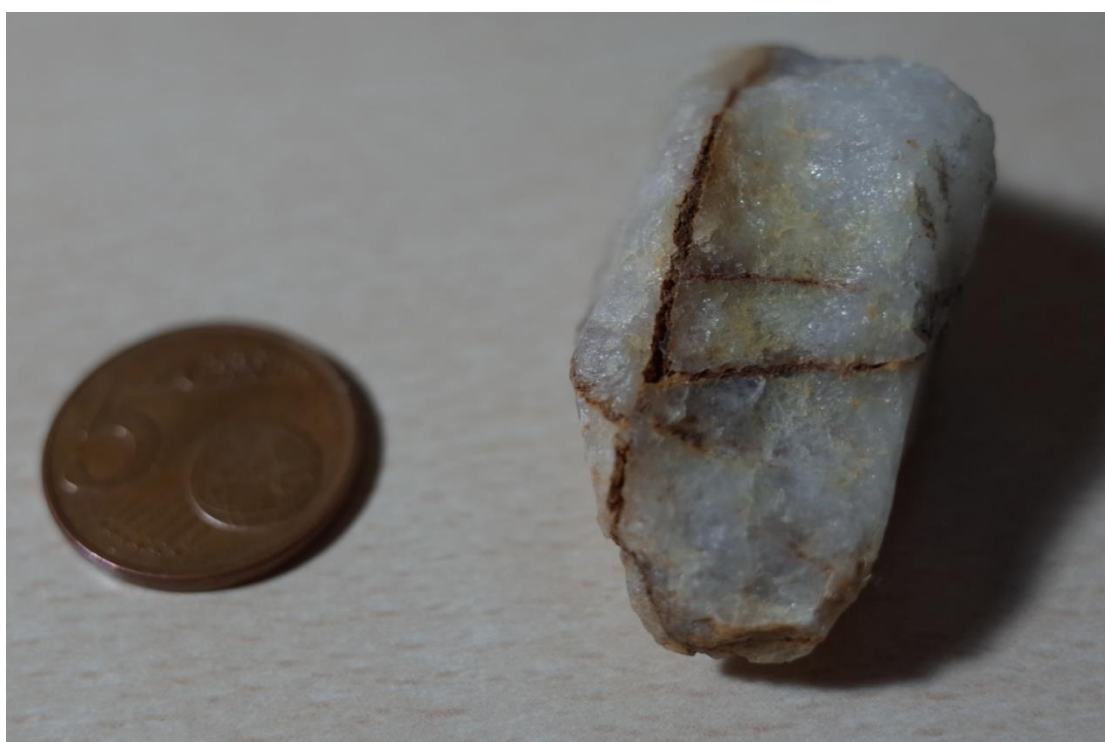
Σχ. 6.1. Δείγμα χαλαζία με αντιμονίτη (τεφρό χρώμα), με ρωγμές πληρωμένες με οξείδια σιδήρου, Ν. Καλλυντήρι.
