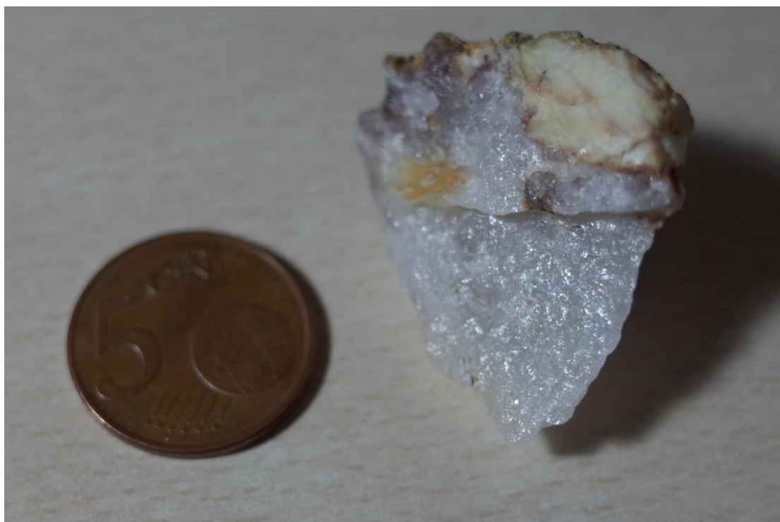
Σχ. 6.2. Δείγμα από χαλαζιακή φλέβα με διάσπαρτο αντιμονίτη, μέσα σε μάρμαρο, Ν. Καλλυντήρι.
