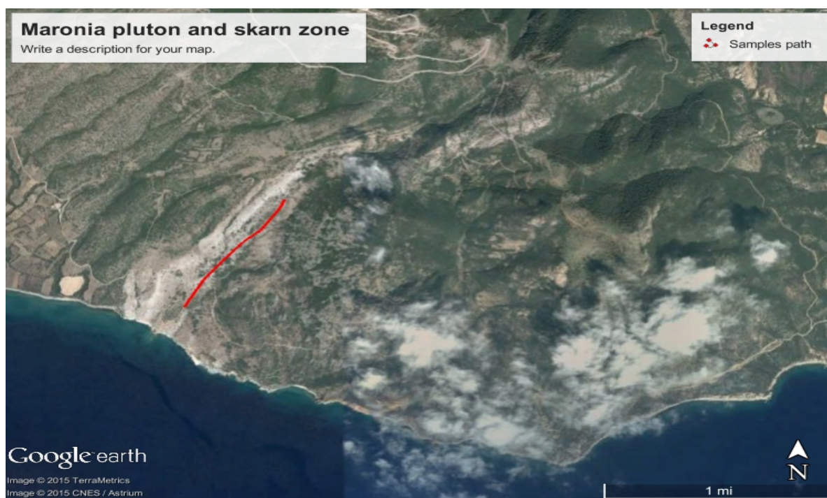
Σχ. 5.1. Εικόνα από το GoogleEarth του πλουτωνίτη της Μαρόνειας και της ζώνης skarn που φαίνεται χαρακτηριστικά. Απεικονίζεται με κόκκινη γραμμή η θέση του skarn από το οποίο λήφθηκαν τα δείγματα σπινελλίου.
