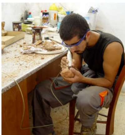
Εικόνα 6α: Εργαστήριο καθαρισμού και συντήρησης απολιθωμάτων με την ειδική βελόνα που δουλεύει με τη βοήθεια πεπιεσμένου αέρα (κομπρεσέρ)
