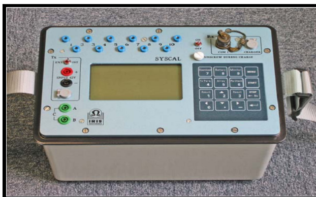
➤ Εικόνα 15. Όργανο μέτρησης ηλεκτρικής αντίστασης (Πηγή : SYSCAL- PRO , IRIS Instruments)
