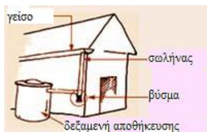
Εικόνα 8: Τρόπος συλλογής όμβριων υδάτων σε αστικές περιοχές
