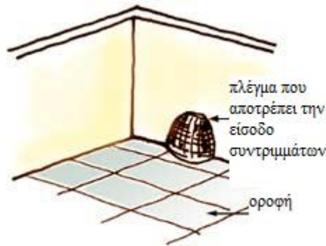
Εικόνα 7: Τοποθέτηση πλέγματος στην οροφή
