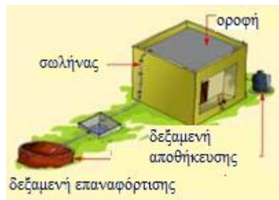
Εικόνα 6: Μέρη ενός τυπικού συστήματος συλλογής βρόχινου νερού
