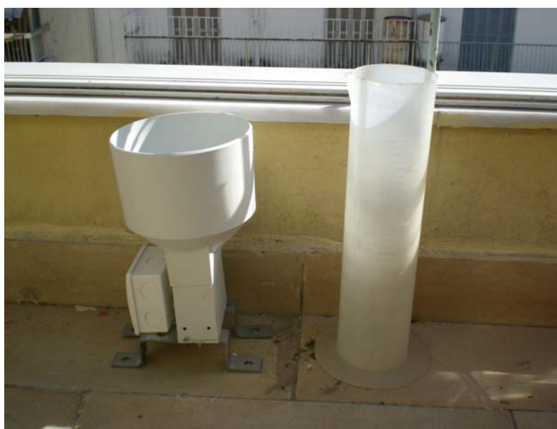
Εικόνα 19: Βροχογράφος ανατρεπτικού ζυγού και ογκομετρικός κύλινδρος
