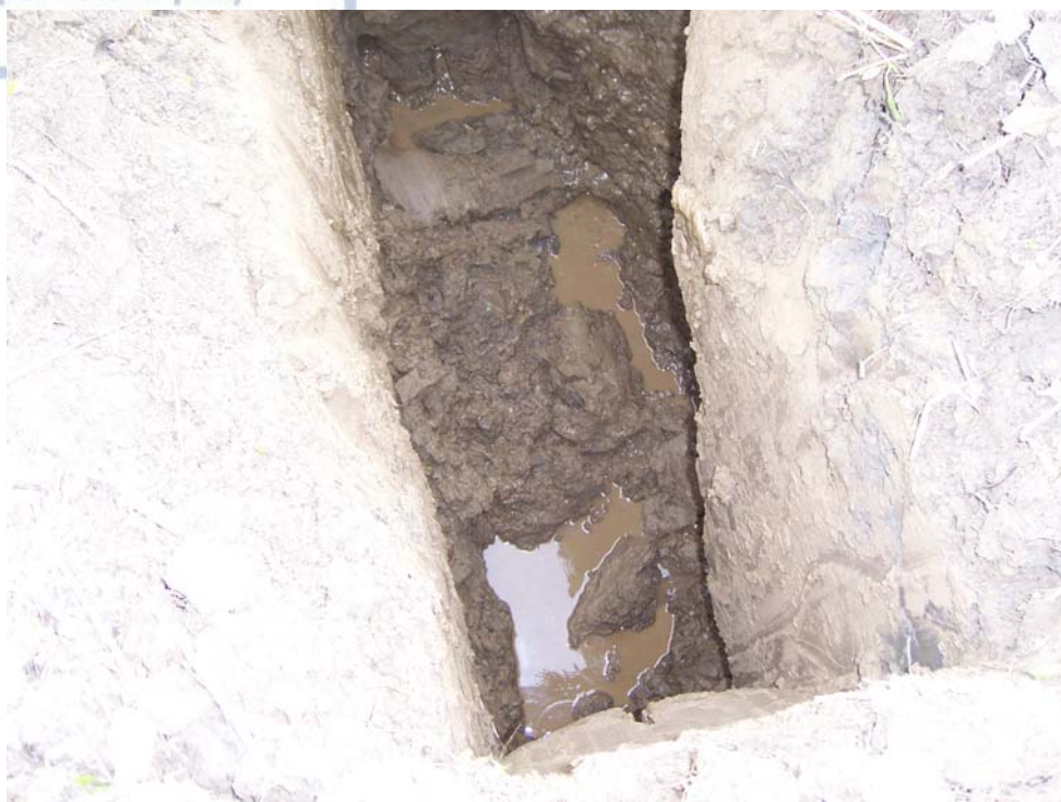
Φωτογραφία 4: Θέση δειγματοληψίας Γ2 στα 2m, όπου συναντήθηκε νερό
