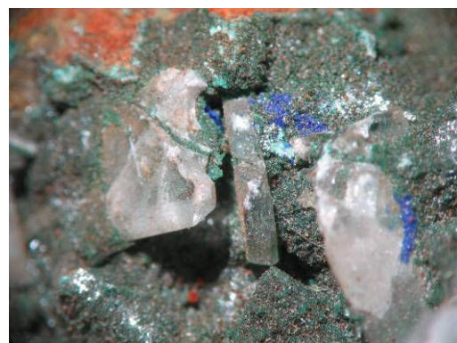
Εικ. 5.19.1. Κονιχαλκίτης από το Λαύριο σε σύμφυση με ασβεστίτη και αζουρίτη, δείγμα Λ100, μήκος φωτογραφίας 10,3 mm. Φωτογραφία σε στερεοσκόπιο.
