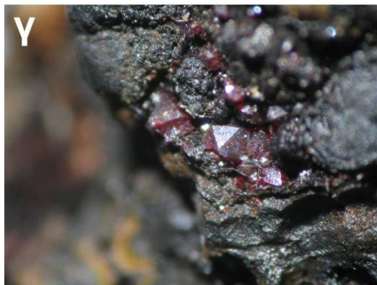
Εικ. 5.21.1. Δείγμα κυπρίτης από το Λαύριο. (α) Κυπρίτης με γκαιτίτη από την Πλάκα, δείγμα 106, μήκος δείγματος 2,5 cm. (β) Κυπρίτης με γκαιτίτη από την Πλάκα, δείγμα A106, μήκος φωτογραφίας 5 mm. Φωτογραφία σε στερεοσκόπιο. (γ) Κυπρίτης με γκαιτίτη από την Πλάκα, δείγμα A106, μήκος φωτογραφίας 4 mm. Φωτογραφία σε στερεοσκόπιο. (δ) Κυπρίτης με γκαιτίτη από την Πλάκα, δείγμα A106, μήκος φωτογραφίας 4 mm. Φωτογραφία σε στερεοσκόπιο.
