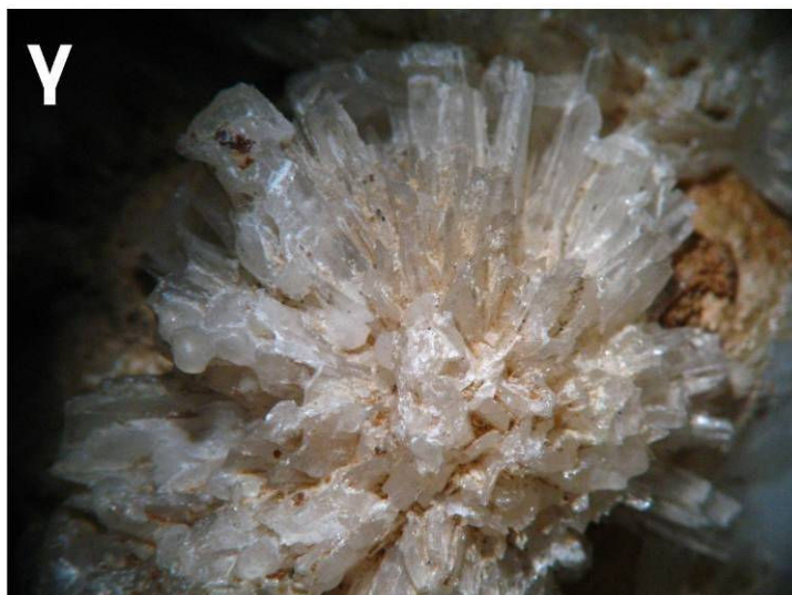
Εικ. 5.7.1. Δείγματα αραγονίτη από το Λαύριο. (α) Αραγονίτης από το Λαύριο, δείγμα Λ024, μήκος δείγματος 5 cm. (β) Αραγονίτης από το Λαύριο, δείγμα Λ081, μήκος δείγματος 5 cm. (γ) Αραγονίτης από το Λαύριο, δείγμα Λ081, μήκος φωτογραφίας 1 cm. Φωτογραφία σε στερεοσκόπιο.
