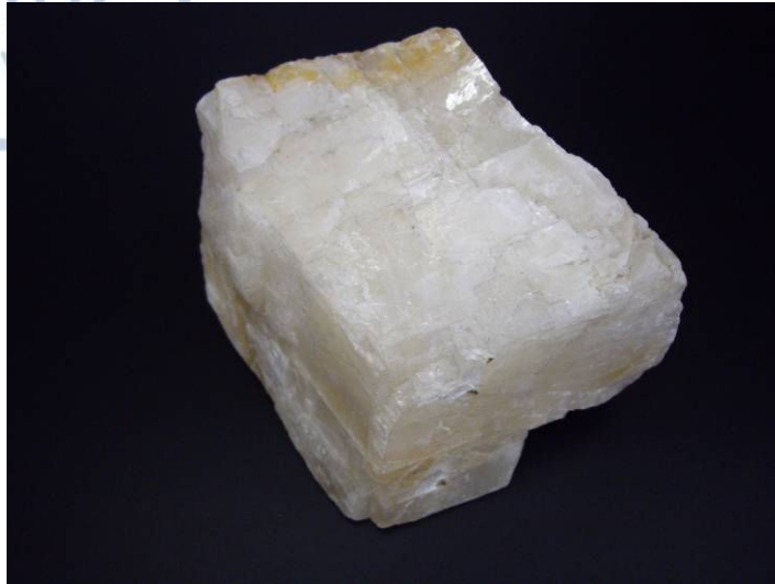
Εικ. 5.9.1. Ασβεστίτης από το Λαύριο, δείγμα Λ126, μήκος δείγματος 5,5 cm.
