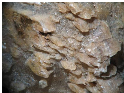
Εικ. 5.15.2. Γύψος από το Λαύριο, δείγμα Λ043, μήκος φωτογραφίας 15,7 mm. Φωτογραφία σε στερεοσκόπιο.
