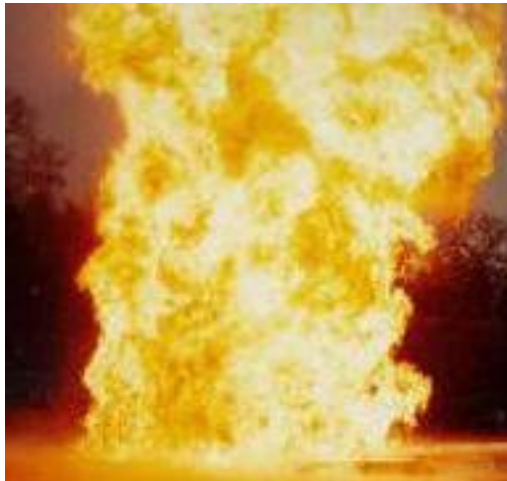
"Πυρκαγιά Λίμνης" από L.N.G. σε μικρής κλίμακας (πείραμα)
