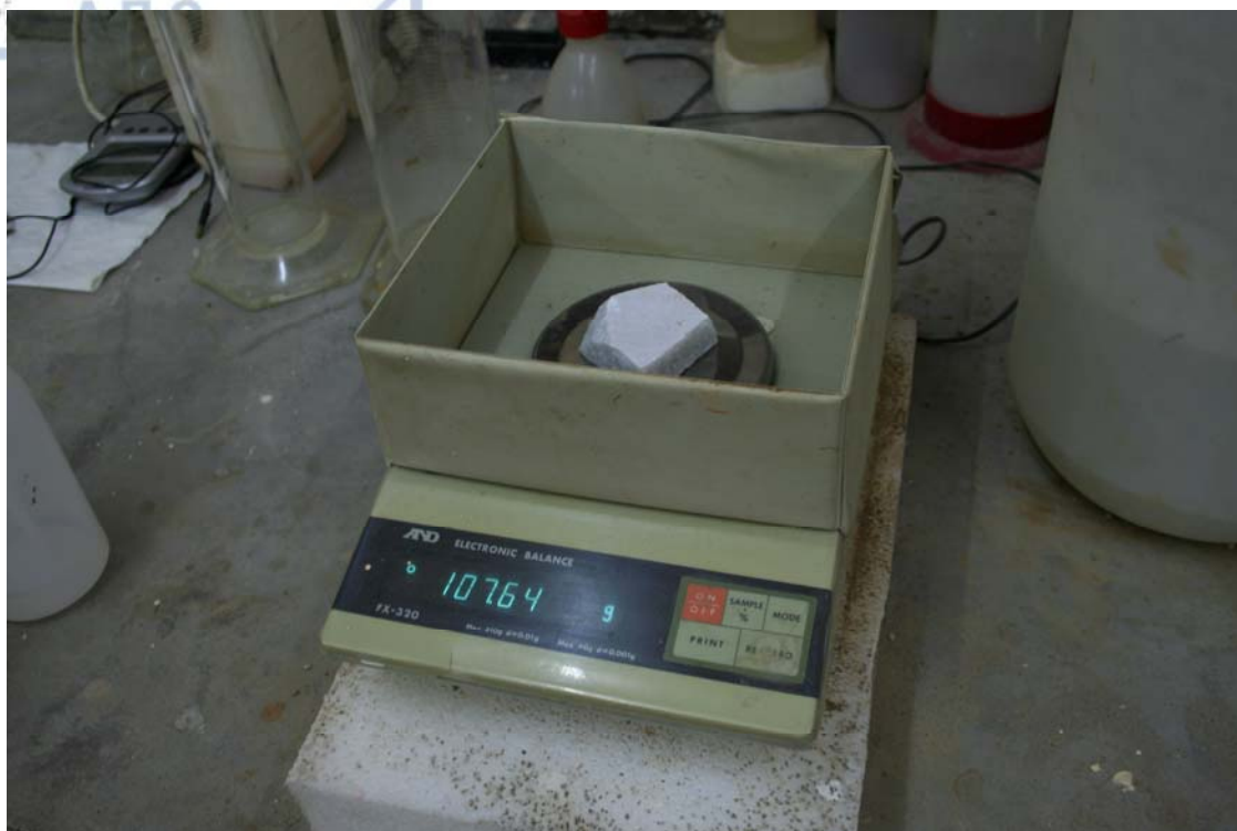
Σχ. 4.10. Ζυγαριά ακριβείας, για την μέτρηση του βάρους ξηρού και κορεσμένου δείγματος.
