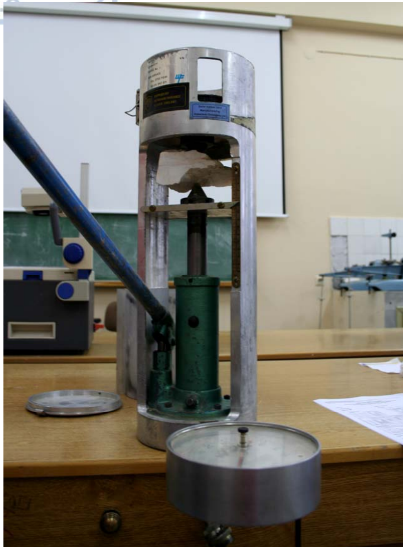
Σχ. 4.7. Μηχάνημα για την μέτρηση της αντοχής σε σημειακή φόρτιση.
