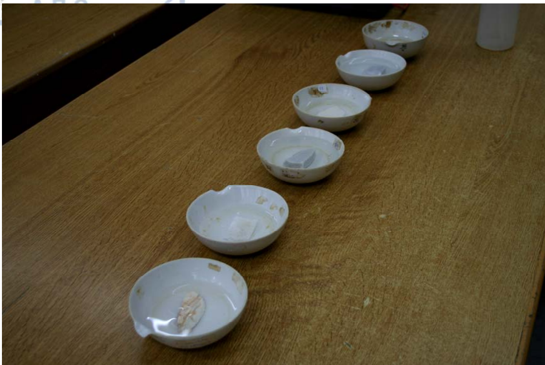
Σχ. 4.9. Τα δείγματα μέσα σε μπολ ανάμιξης με νερό για να κορεστούν.
