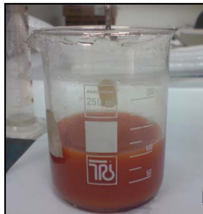
Σχήμα 6.3: α) Αρχικό χρώμα δείγματος, πριν την προσθήκη διαλύματος νιτρικού αργύρου, β) το δείγμα χρωματίζεται μετά την προσθήκη του νιτρικού αργύρου.
