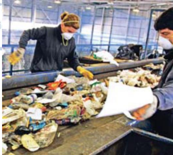
Εικ.13: Διαχωρισμός απορριμμάτων σε μονάδα επεξεργασίας (Πηγή: Εφημερίδα πολίτης 2015)
