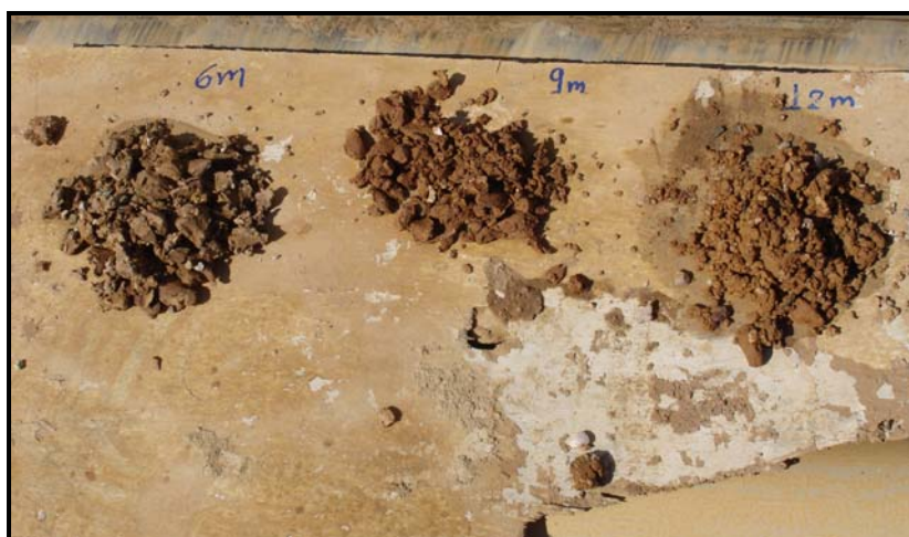
Εικόνα 14. Τοποθέτηση δειγμάτων σε κόντρα- πλακέ.
