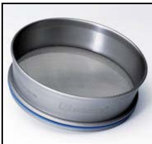
Εικόνα 22. Ανοξείδωτο εργαστηριακό κόσκινο.
