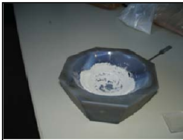
Εικόνα 20. Αχάτινο χειροκίνητο γουδί για την κονιοποίηση μικρών ποσοτήτων υλικού.
