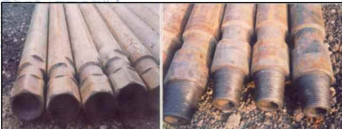
Εικόνα 4. Στελέχη. Κάθε σωλήνας έχει στο ένα άκρο του εσωτερικό σπείρωμα και στο άλλο άκρο του εξωτερικό. Με τη βοήθεια του σπειρώματος συνδέονται μεταξύ τους προς σχηματισμό στήλης.
