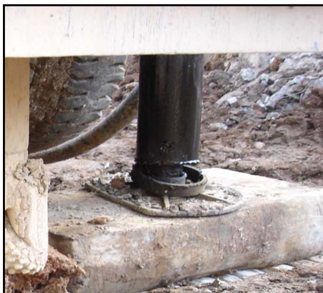
Εικόνα 6. Ποδαρικό του γεωτρύπανου, το οποίο βοηθάει στην ισορροπία και σταθερότητα του μηχανήματος.
