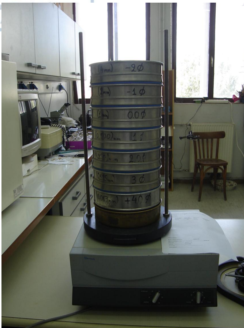
Φωτογραφία 1: Κόσκινα σε διάταξη ανά 1 Φ και μηχανήμα δόνησης στο εργαστήριο ιζηματολογίας του Τομέα Φυσικής & Περιβαλλοντικής Γεωγραφίας, Α.Π.Θ. (Ιούλιος 2011)
