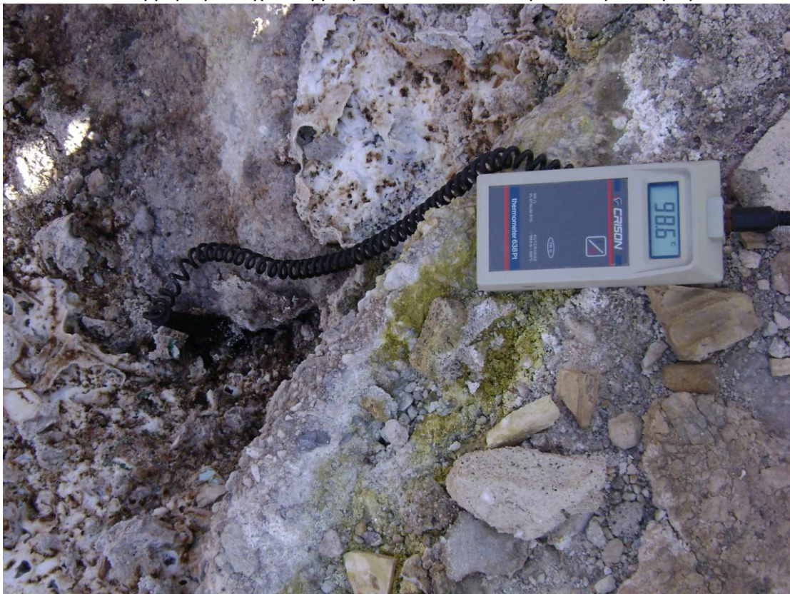
ΣΧΗΜΑ 3.3 : Θερμόμετρο δείχνει θερμοκρασία 98.6 °C σε επιφανειακές συνθήκες
