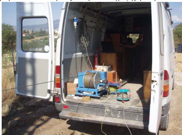
Φωτογραφία 14. Αυτοκίνητο εξοπλισμού καταγραφής ηλεκτρικών διαγραφιών.
