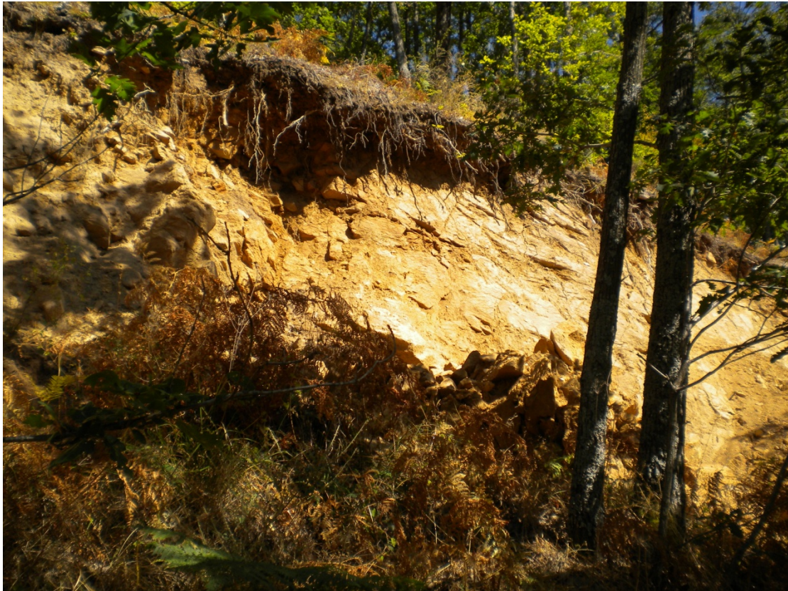
Φωτογραφία . Το φρύδι της κατολίσθησης του O28.
