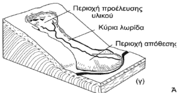
Σχήμα 2.13. Ροή γαιών (Zaruba-Mencl)
