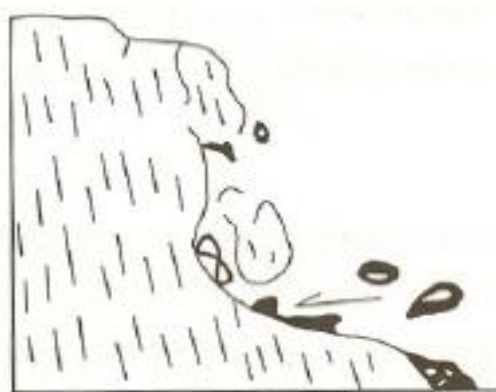
Σχήμα 2.1.(α) Πτώση βράχου και (β) ανατροπή βράχου (κατά Varnes)
