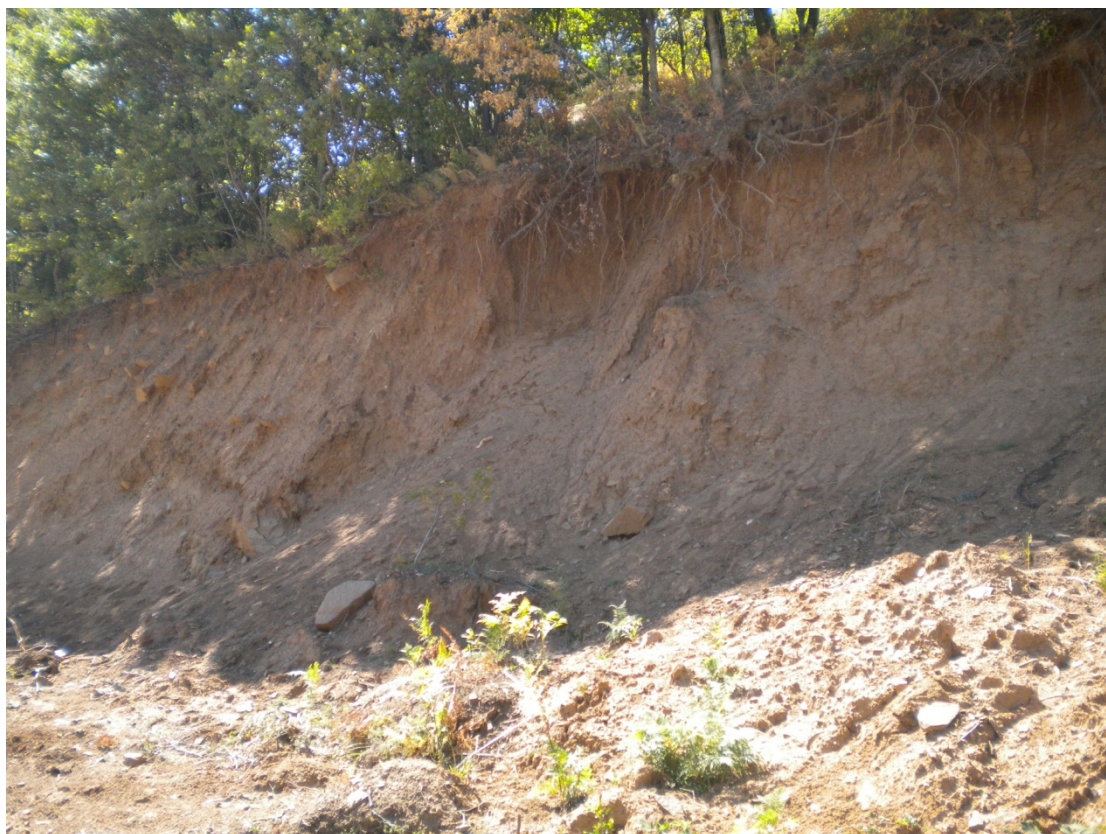
Φωτογραφία 5.6. Πολύ αποσαθρωμένη γνευσιακή βραχώμαζα της περιοχής μελέτης. GSI=20-30
