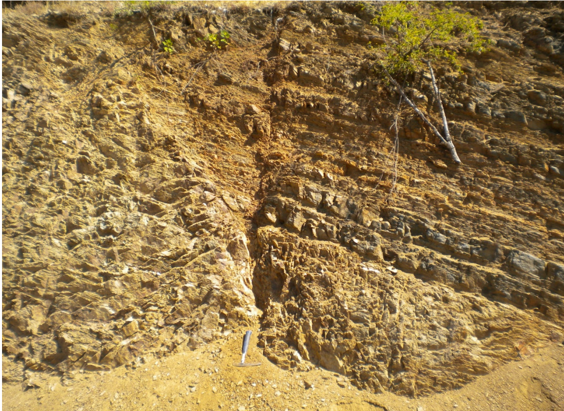
Φωτογραφία 4.4. Τύπος IV γνευσιακής βραχόμαζας στην περιοχή μελέτης. GSI=30-40
