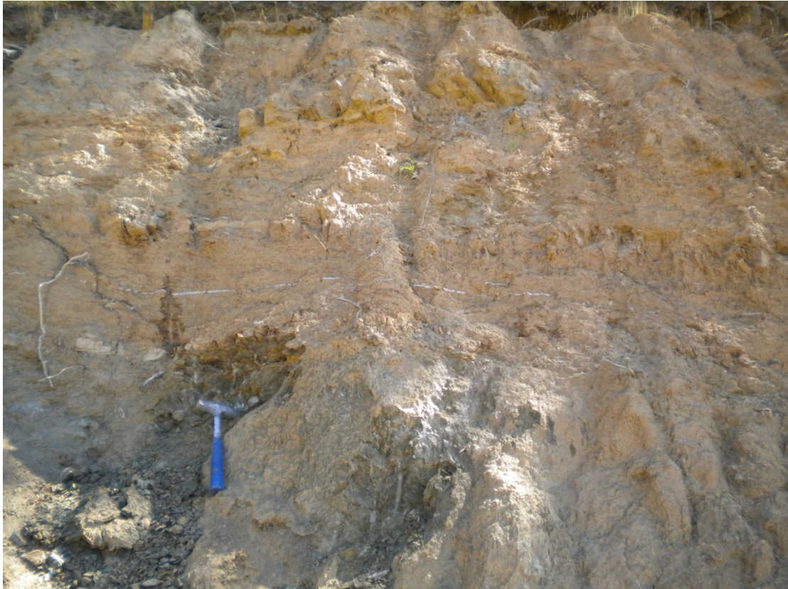
Φωτογραφία 4.7. Τύπος VII γνευσιακής βραχόμαζας στην περιοχή μελέτης. GSI=10-20
