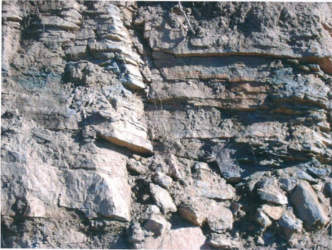
Φωτογραφία 4.3. Τύπος ΙΙΙ γνευσιακής βραχόμαζας στην περιοχή μελέτης. GSI=45-60
