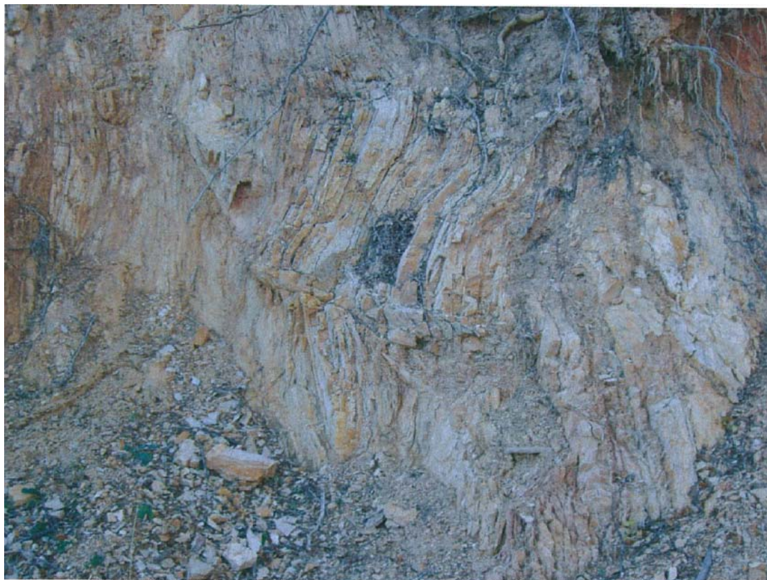
Φωτογραφία 4.5. Τύπος V γνευσιακής βραχόμαζας στην περιοχή μελέτης. GSI=25-40
