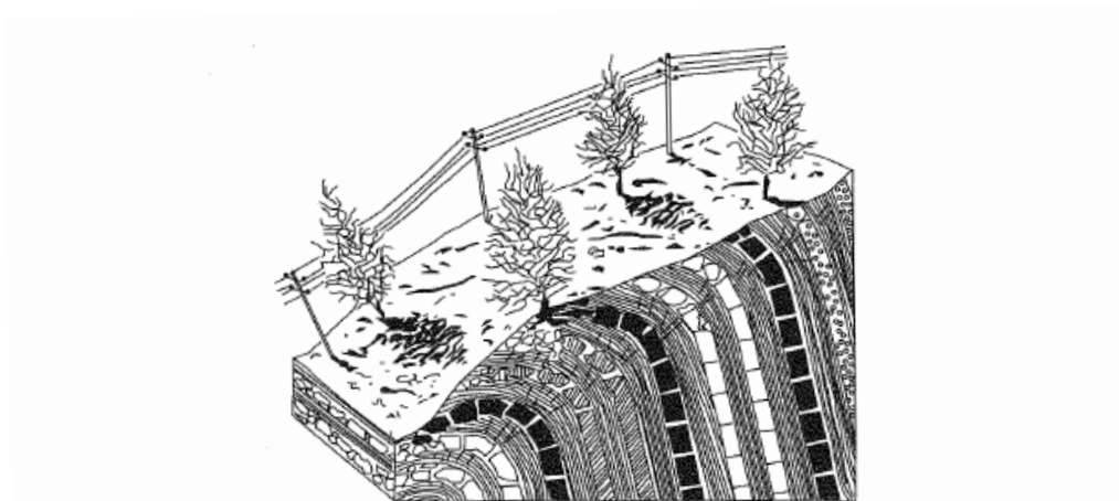
Σχήμα 2.11. Βαρυτικός ερπυσμός. ( Desio 1959)
