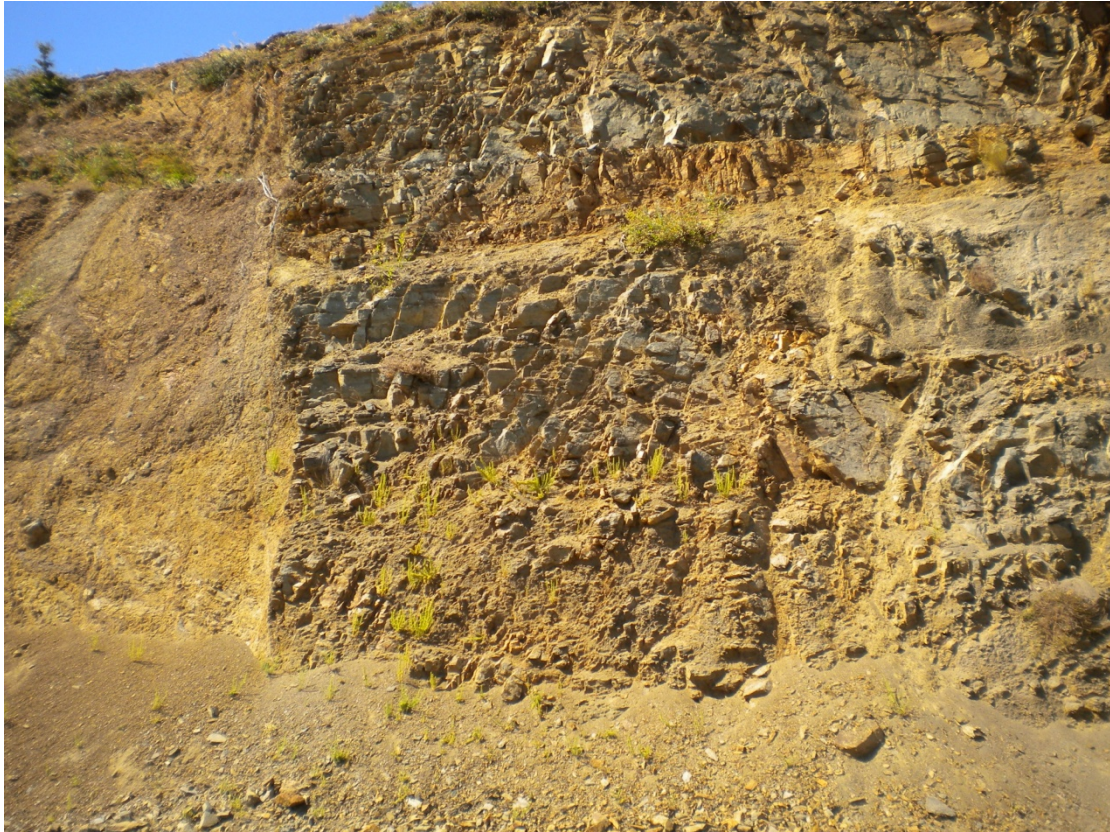
Φωτογραφία 4.2. Τύπος II γνευσιακής βραχόμαζας στην περιοχή μελέτης. GSI=50-60
