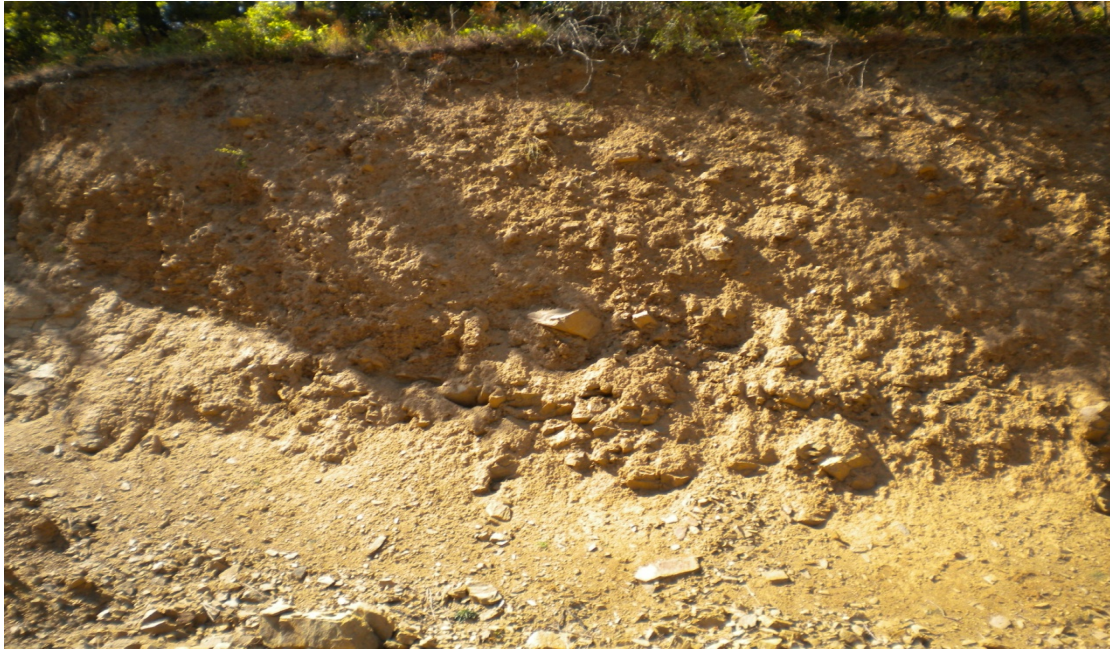
Φωτογραφία 4.6. Τύπος VI γνευσιακής βραχόμαζας στην περιοχή μελέτης. GSI=20-30
