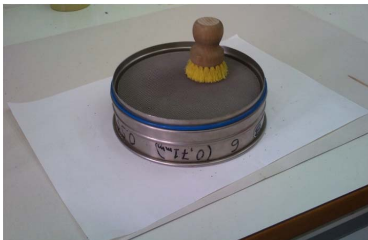
Εικόνα 4.5: Καθαρισμός του κόσκινου με ειδικό βουρτσάκι.
