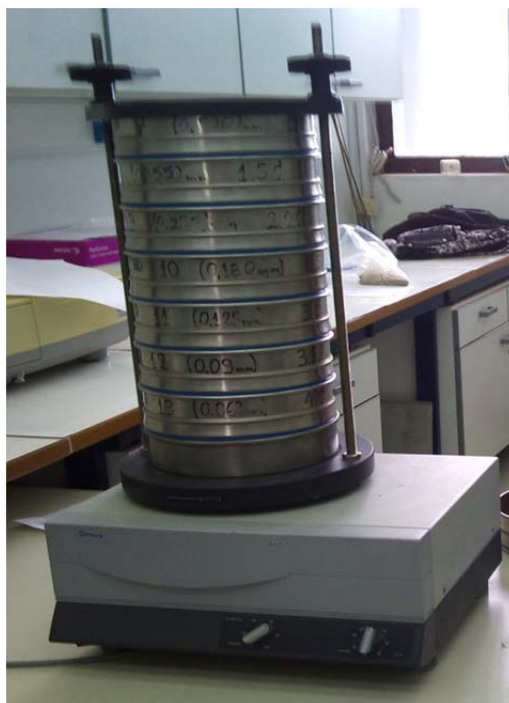
Εικόνα 4.4: Ο δονητής που γίνεται το κοσκίνισμα.
