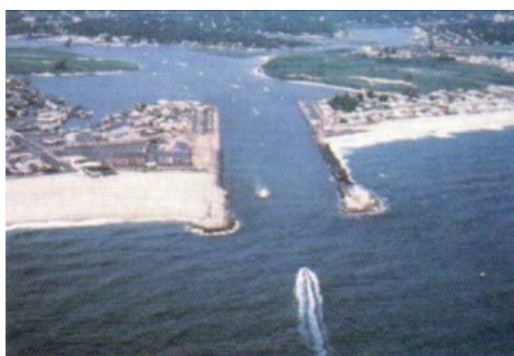
Εικόνα 3.5: Η επίδραση των μώλων στη μορφή των αμμωδών ακτών. (URL 6 )
