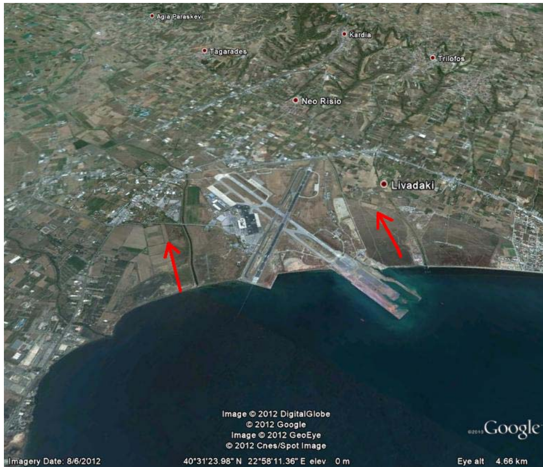
Εικόνα 2. Δορυφορική εικόνα της εξεταζόμενης περιοχής. Στην εικόνα απεικονίζεται το αεροδρόμιο "Μακεδονία" σε σχέση με το Νέο Ρύσιο. Τα κόκκινα βέλη δείχνουν ακριβώς την διάταξη των γεωηλεκτρικών μετρήσεων στο έδαφος της περιοχής που χρησιμοποιήθηκαν για την βυθοσκόπηση. (Google earth 2012)
