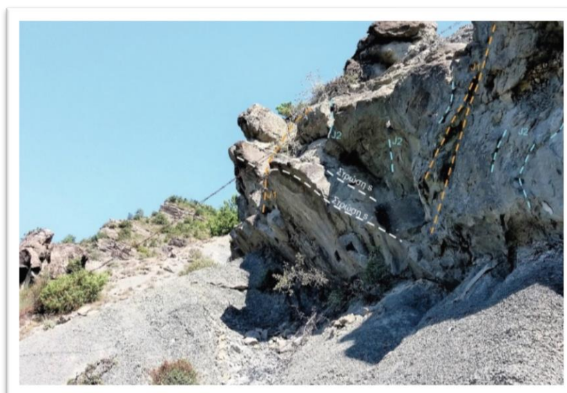
Σχήμα 4.12 Κύριες ασυνέχειες βραχόμαζας, όπως εντοπίστηκαν στη θέση μέτρησης στοιχείων προσανατολισμού ασυνεχειών
