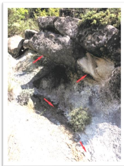
Σχήμα 4.18 Θέσεις μέτρησης με τη σφύρα Schmidt σε ιλυολιθικούς και ψαμμιτικούς οριζόντες
