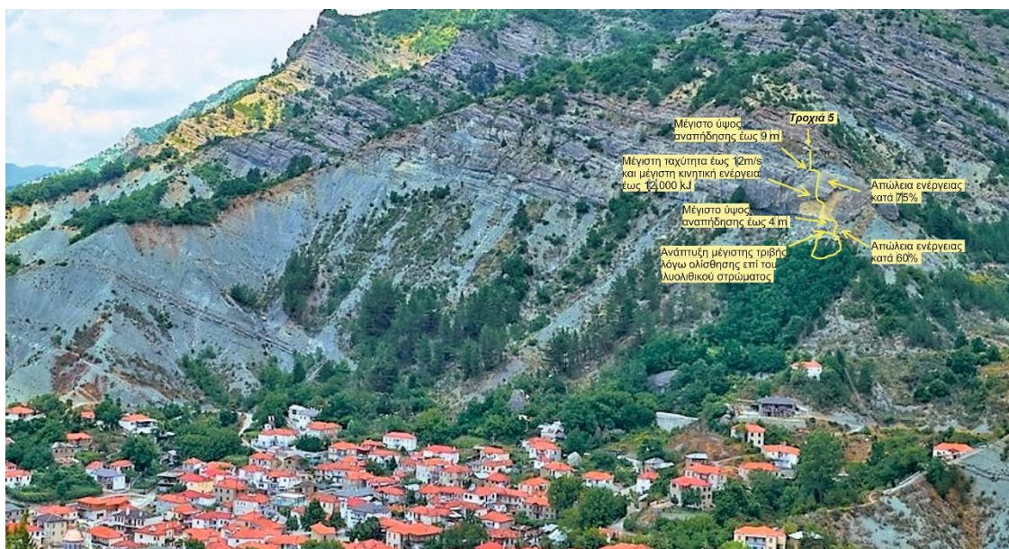
Σχήμα 5.30 Απεικόνιση στο πεδίο μίας (1) δυσμενούς τροχιάς (Τροχιά 5) τεμάχους του Τομέα 3
