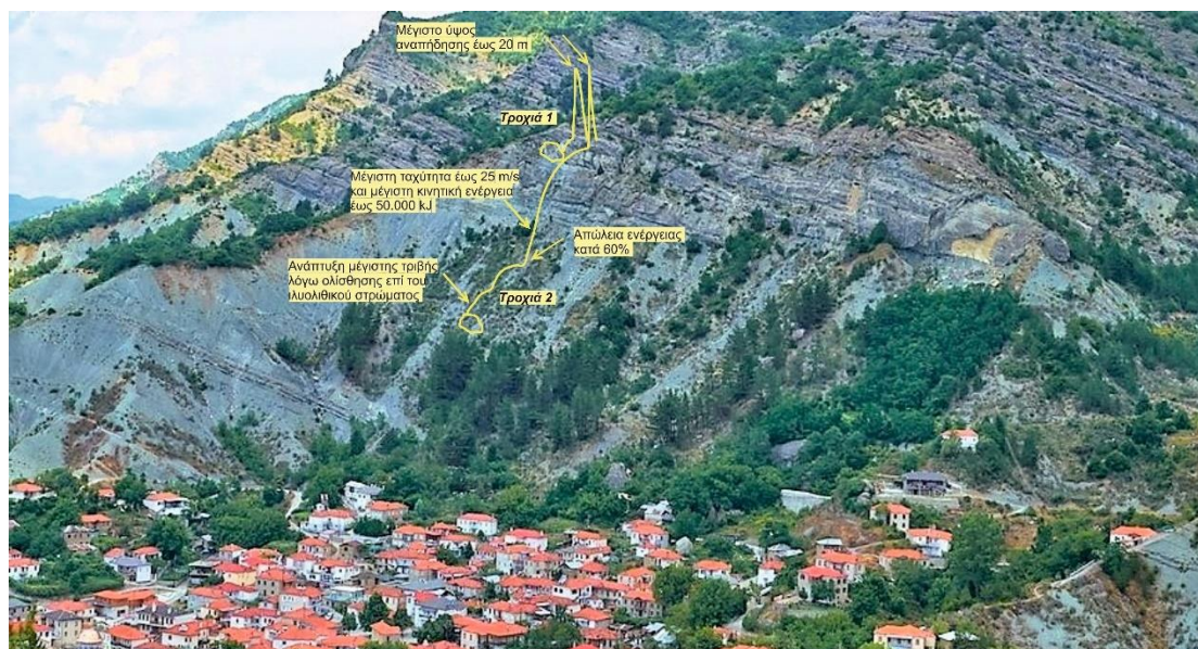
Σχήμα 5.22 Απεικόνιση στο πεδίο των δύο (2) δυσμενέστερων τροχιών (Τροχιά 1 και 2) τεμαχών του Τομέα 1
