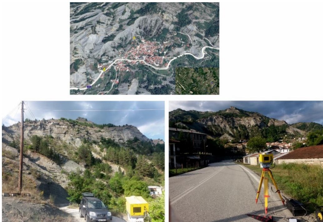
Σχήμα 4.3 Θέσεις επίγειας σάρωσης LiDAR πρανούς, χάρτης θέσεων (επάνω), Θέση 1 (κάτω αριστερά), Θέση 2 (κάτω δεξιά)
