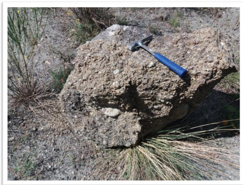
Σχήμα 2.9 Πολύμεικτα κροκαλοπαγή καλά συγκολλημένα. Λήψη πεσμένου τεμάχους παλαιάς κατολίσθησης από αγροτικό δρόμο ανατολικά του πρανού (φωτογραφία από προσωπικό αρχείο, ημερομηνία λήψης 18/07/2018)
