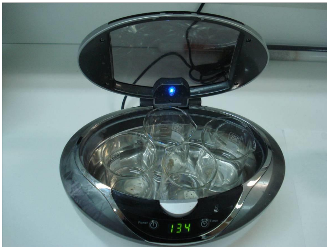
Σχήμα 4.1.5: Ειδική συσκευή για πλύσιμο με υπερήχους
