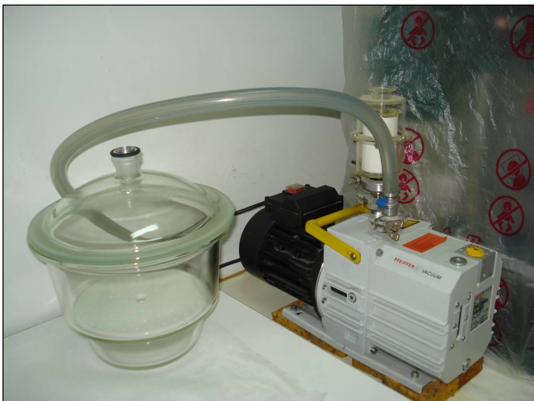
Σχήμα 4.1.3: Αντλία κενού συνδεδεμένη με ξηραντήρα κενού.
