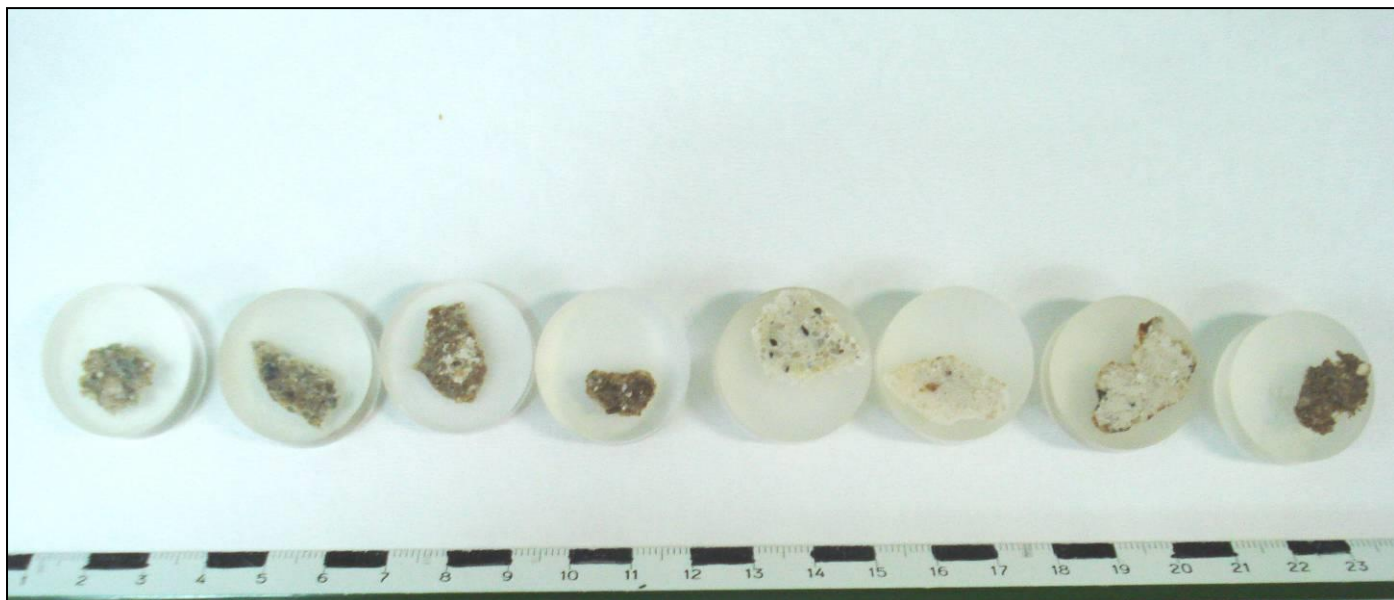
Σχήμα. 4.1.4: Τα δείγματα μετά τον εγκιβωτισμό και λείανση
