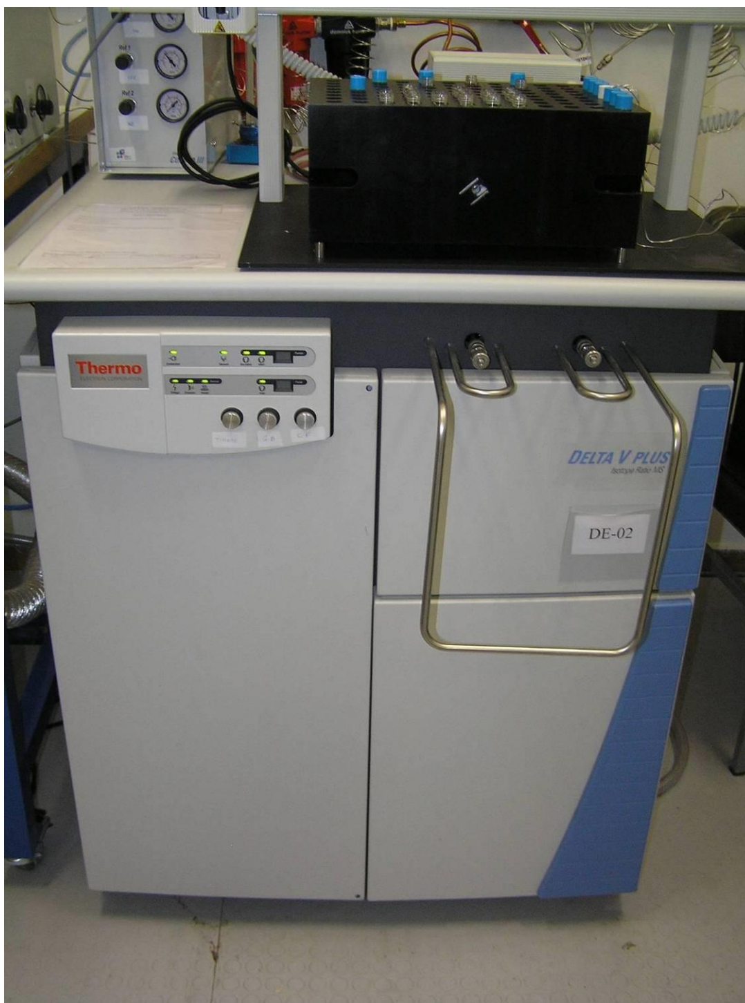
Σχήμα 4.2.7: Φασματογράφος μάζας σταθερών ισοτόπων
