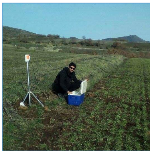
Εικ. 4.3.2 – 4.3.3. Φωτογραφίες από τη περιοχή Ριζό. Αριστερά είναι το μαγνητόμετρο όδευσης και δεξιά ο μαγνητικός σταθμός βάσης
