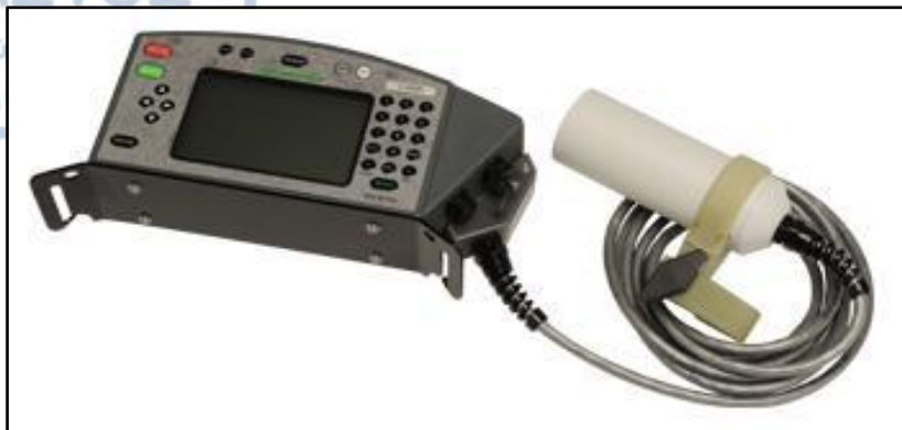
Εικ. 4.3.1. Μαγνητόμετρο Kaiσίου της εταιρίας Geometrics
